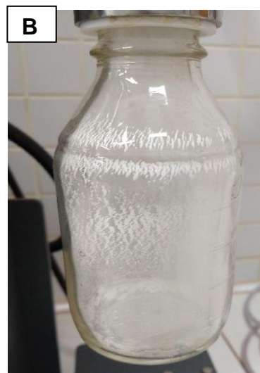
Figura 10 – A - Spray dryer utilizado para produção das micropartículas. B – coletor das micropartículas (ampliado).
