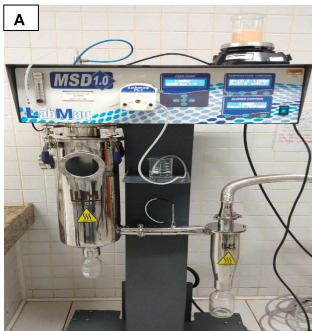
Figura 10 – A - Spray dryer utilizado para produção das micropartículas. B – coletor das micropartículas (ampliado).
