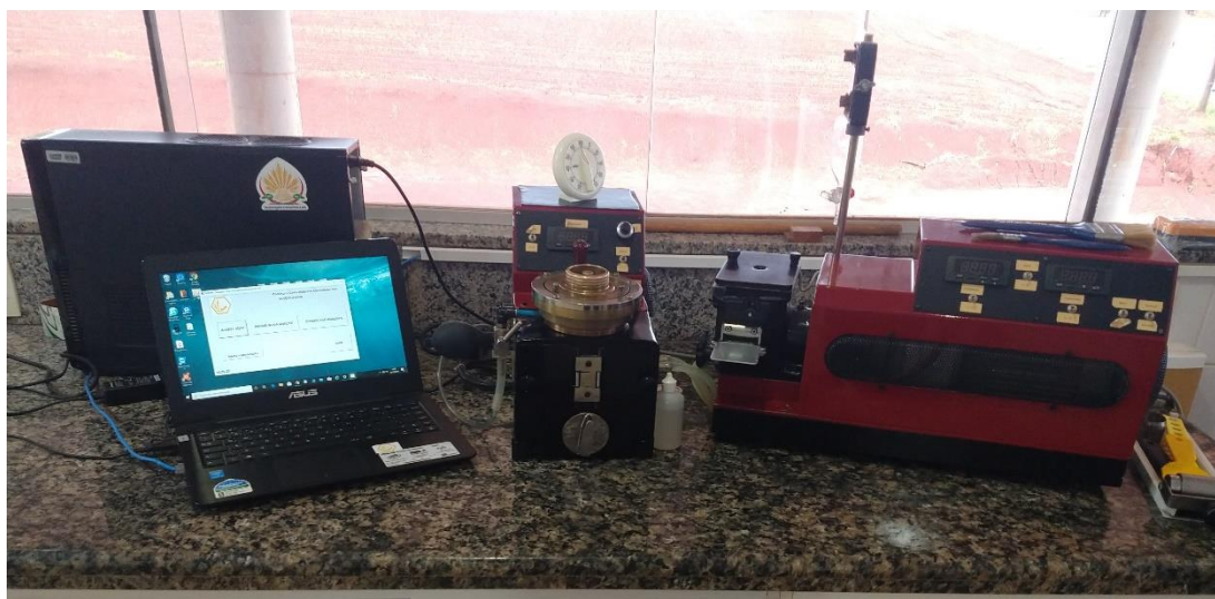
Figura 11 - Alveógrafo Chopin utilizado para análise de alveografia.
