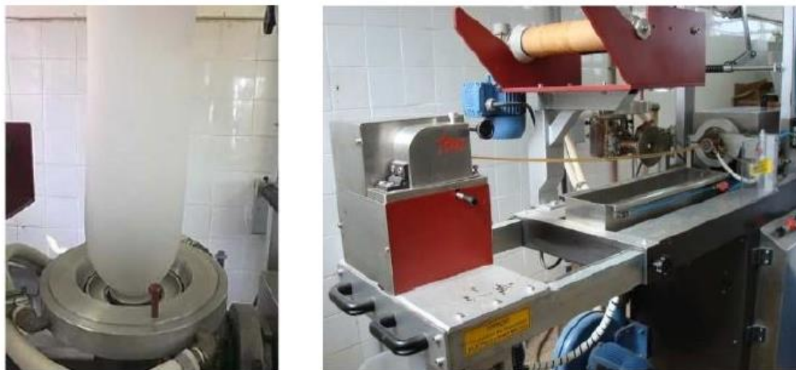
Figura 8 – Formação do balão e extrusora monorosca utilizada para fabricação de filmes por extrusão – sopro em balão.
