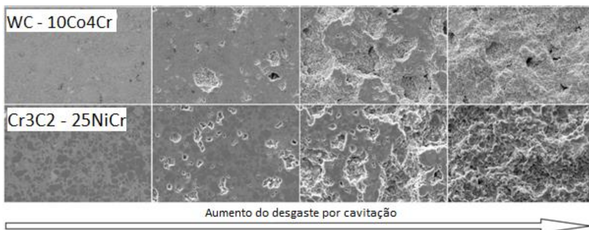
Figura 13 - Desenvolvimento do desgaste por cavitação dos revestimentos de WC e Cr 3 C 2 Fonte: Adaptado de Matikainen et al. (2018)
