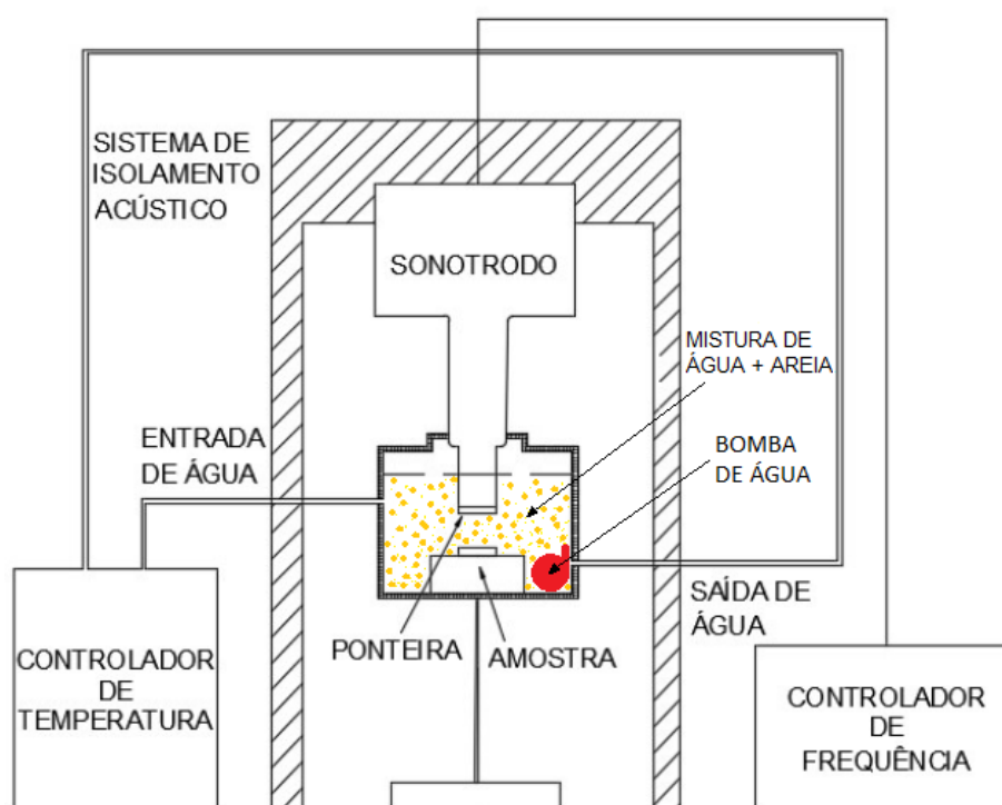
Figura 26 - Representação esquemática da instalação da bomba de água para circulação da solução de água com areia
