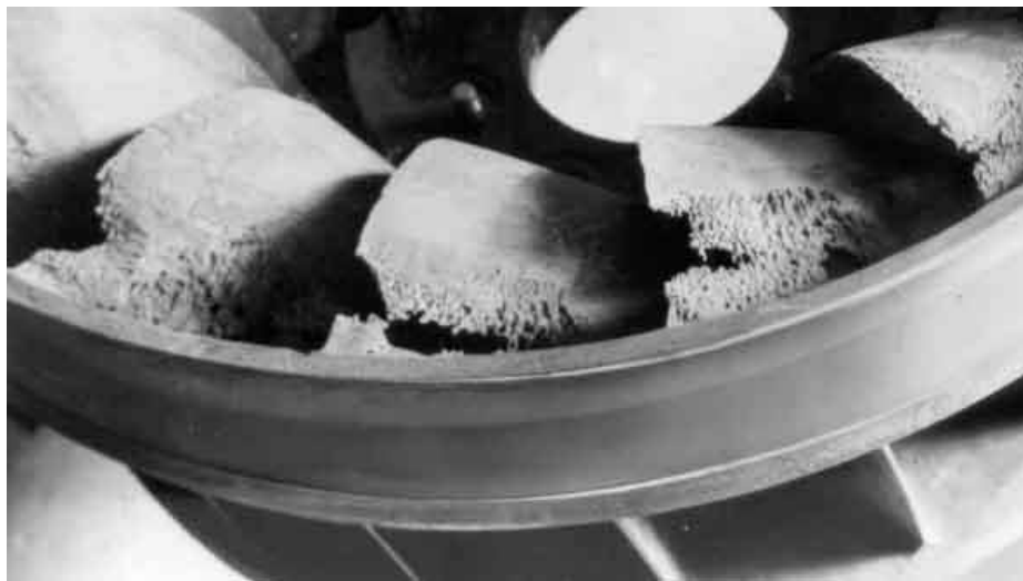
Figura 15 - Cavitação em pás de descarga de uma turbina Francis Fonte: Brennen (2005)
