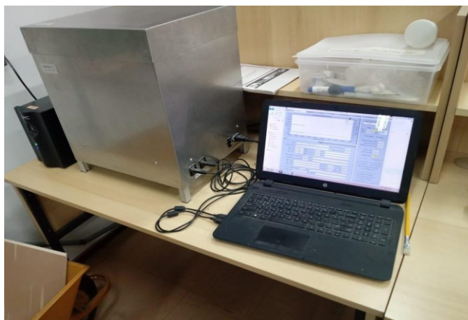
Figura 16: Aparelho de calorimetria de condução. Fonte: Arquivo pessoal.
