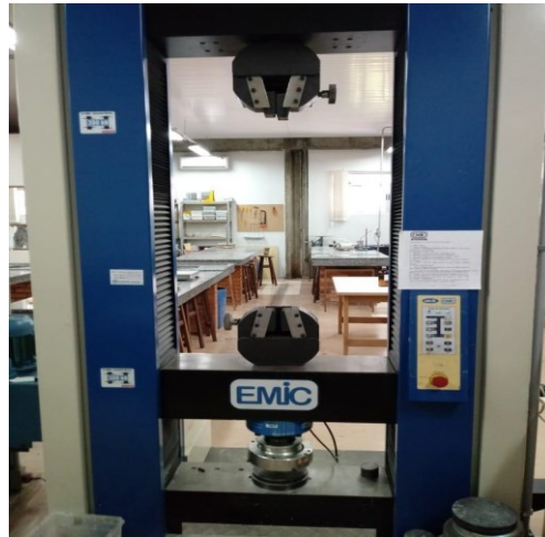
Figura 17: Equipamento de teste para resistência à compressão. Fonte: Arquivo pessoal.
