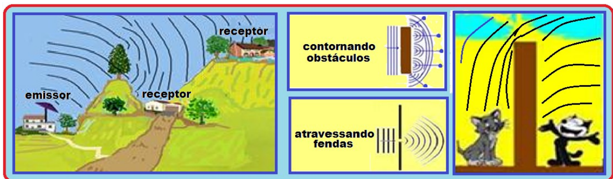
Figura 9 - Representação da difração do som
