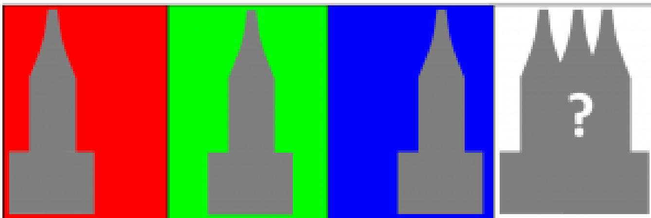
Figura 2 – Sombras na parede para o sistema caixa-garrafa quando cada uma das lâmpadas está lidada e quando as três estão ligadas.
