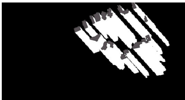
Figura 53 – Imagem arquivo formato raster de sombreamento dos edifícios no entorno da Praça do Japão no horário das 15:00 horas solstício de inverno 21/06/2016 - Software R
