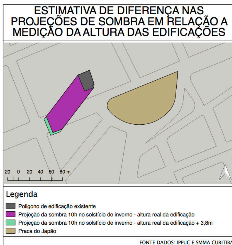
Figura 39 – Estimativa de diferença nas projeções de sombra a partir de altura obtida in loco e através do método indireto
