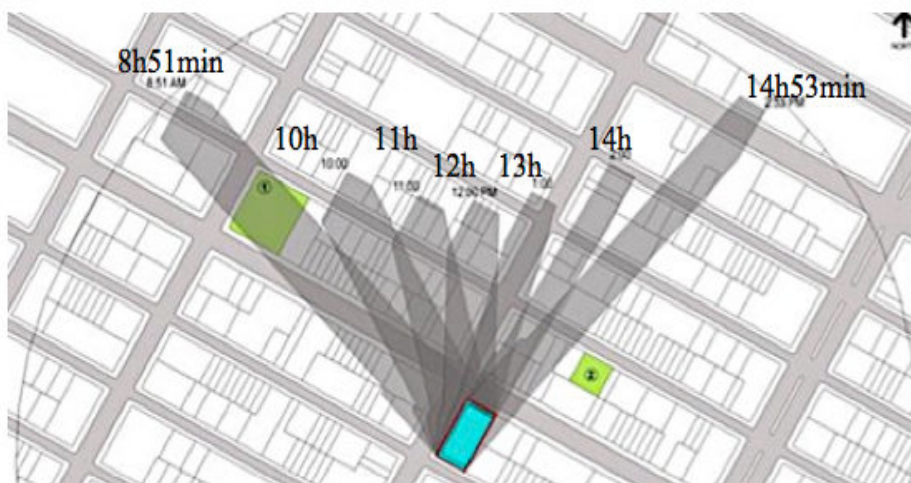
Figura 2 – Exemplo de modelagem de análise de sombreamento para o solstício de inverno – SEQRA
