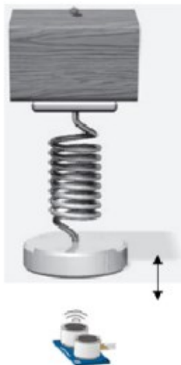
Figura 15: Representação da medida experimental no experimento massa-mola.
