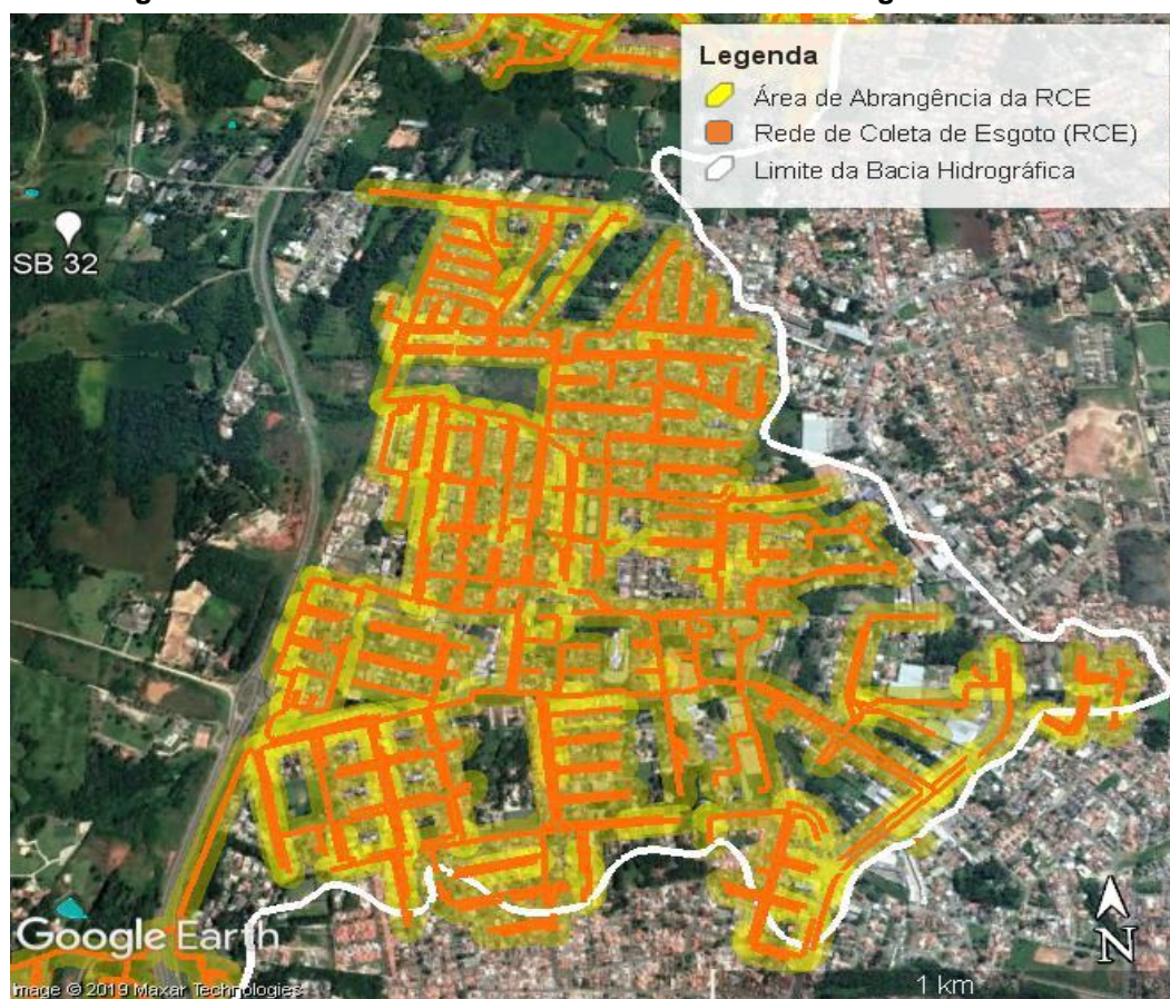
Figura 14 – Trecho da Sub-bacia SB 32: Área de Abrangência da RCE
