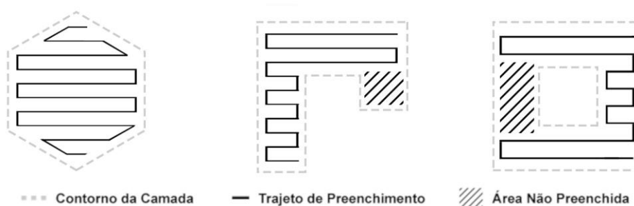
Figura 10 – Contornos complexos necessitam de mais de um zigue-zague
