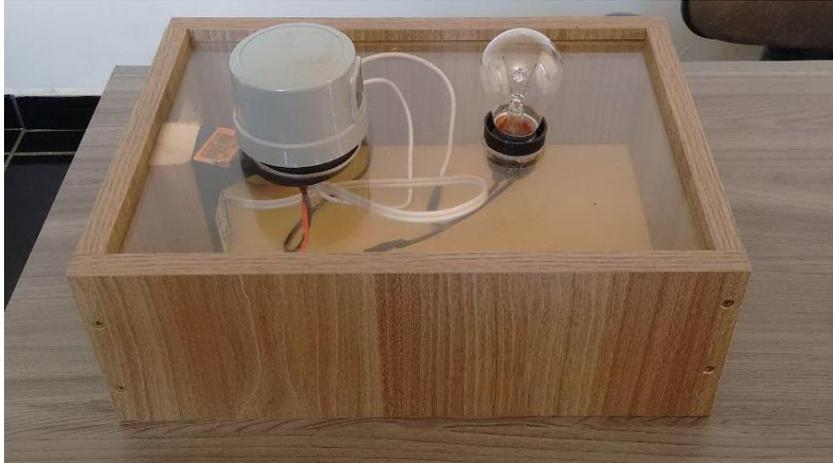
**Figura 6** - Circuito composto de um sensor de luminosidade e uma lâmpada.
