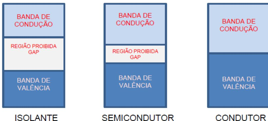
**Figura 1** – Bandas de condução e valência de um isolante, semicondutor e condutor.
