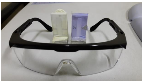
Figura 20 – Óculos e luvas cirúrgicas são elementos de proteção médica em procedimentos cirúrgicos. A absorvância de cada um foi medida para avaliar o nível de proteção radiológica que apresentam. A luva azul possui uma espessura de 40 \mu\text{m} , a branca com 70 \mu\text{m} e os óculos 2,15 mm.
