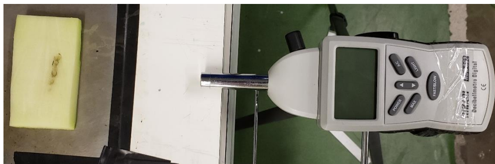
Figura 29 - Medidor de pressão acústica - Decibelímetro digital - da marca Hikari – HDB-882. Utilizado na medição do nível sonoro da faísca elétrica.
