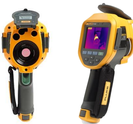
Figura 22 – Câmera Infravermelha – FLUKE®. Usada para registrar e medir as diferentes temperaturas no tecido biológico durante e após a faiscância.
