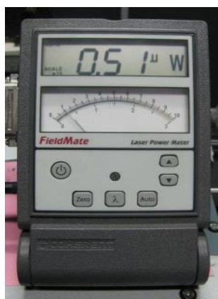
Figura 17 – Medidor de Potência. Após cada espectro medido foram realizadas medições da potência luminosa nas mesmas condições do processo de faiscância.
