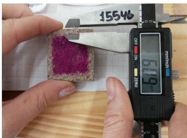
Figura 4: Medição da carbonatação com paquímetro digital Fonte: Autoria própria (2019).
