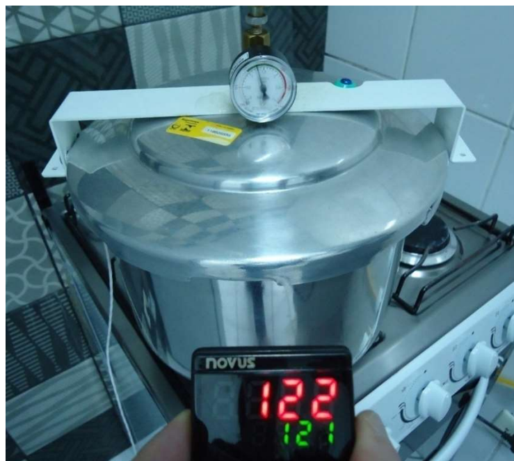
Figura 13 - Foto do protótipo com a indicação da temperatura interna durante o ciclo
