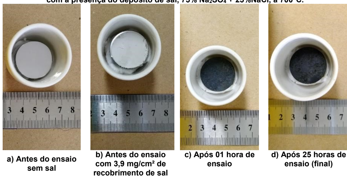
Figura 38 - Evolução da superfície da amostra de Waspaloy submetida a corrosão a quente com a presença do depósito de sal, 75% Na 2 SO 4 + 25%NaCl, à 700°C.
