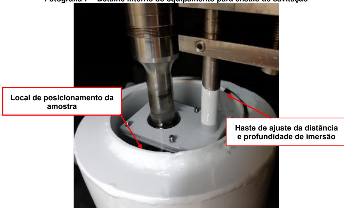
Fotografia 7 – Detalhe interno do equipamento para ensaio de cavitação
