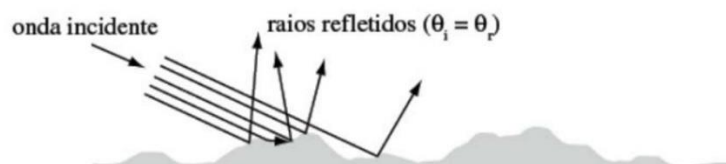
Figura 8 – Princípio físico da reflexão difusa ocorrido em superfícies rugosas, utilizado em técnicas ópticas para avaliação de rugosidade
