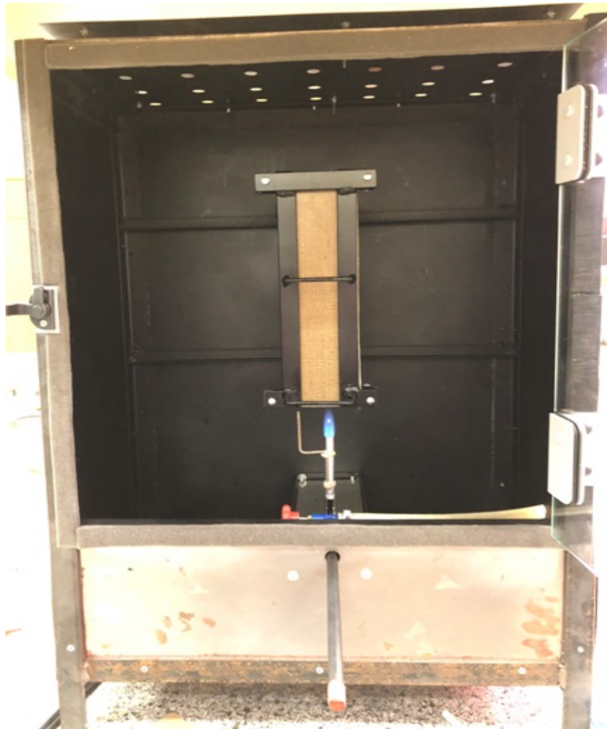
Figura 36 - Amostra no porta-amostra do gabinete durante regulagem da altura da chama
