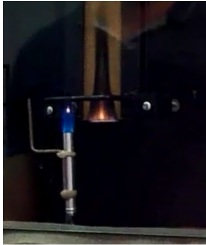
Figura 43 - Tempo de chama no compósito após a retirada do queimador
