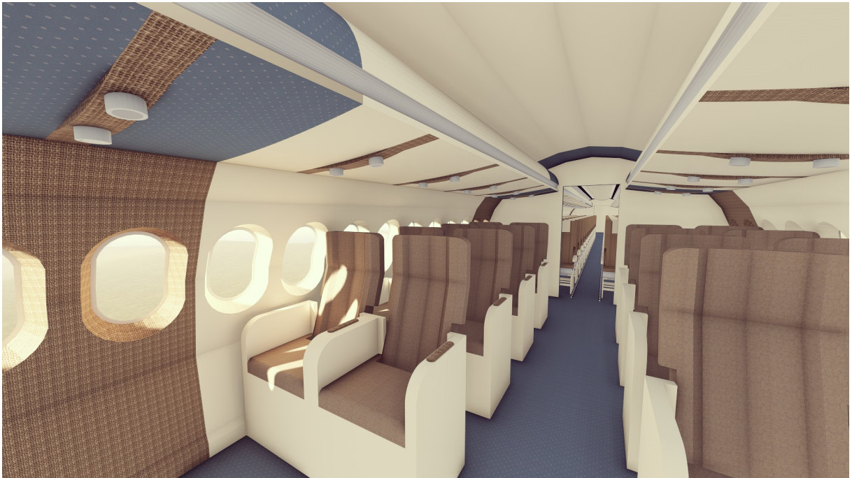
Figura 65 – Modelagem eletrônica da cabine de passageiros com aplicação do compósito em componentes de revestimento
