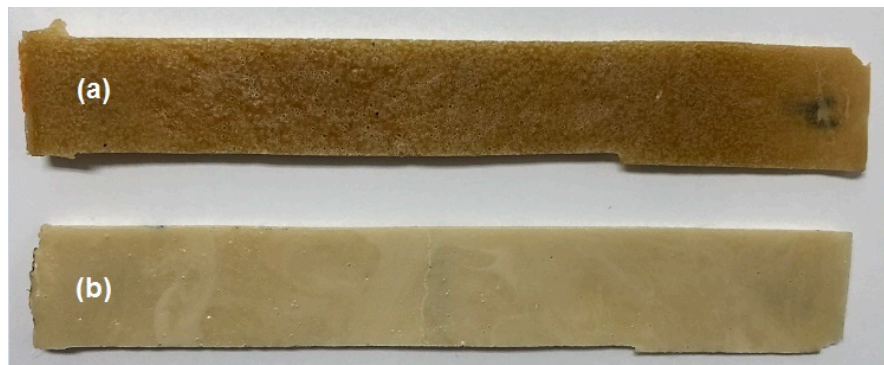
Figura 28 - Amostras de (a) PU e (b) PU/ATH cortadas de placas moldadas
