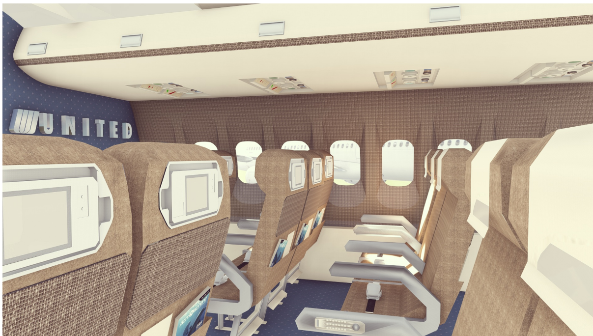
Figura 67 - Simulação da cabine de passageiros com aplicação do compósito nas mesas individuais dos assentos, nos painéis de revestimento laterais e acabamento do compartimento para bagagens de mão
