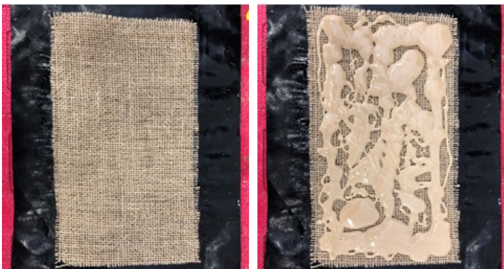
Figura 30 - (a) Tecido de juta empilhado sobre folha de PP untada com vaselina e (b) PU/ATH distribuído sobre 2 camadas de tecido de juta
