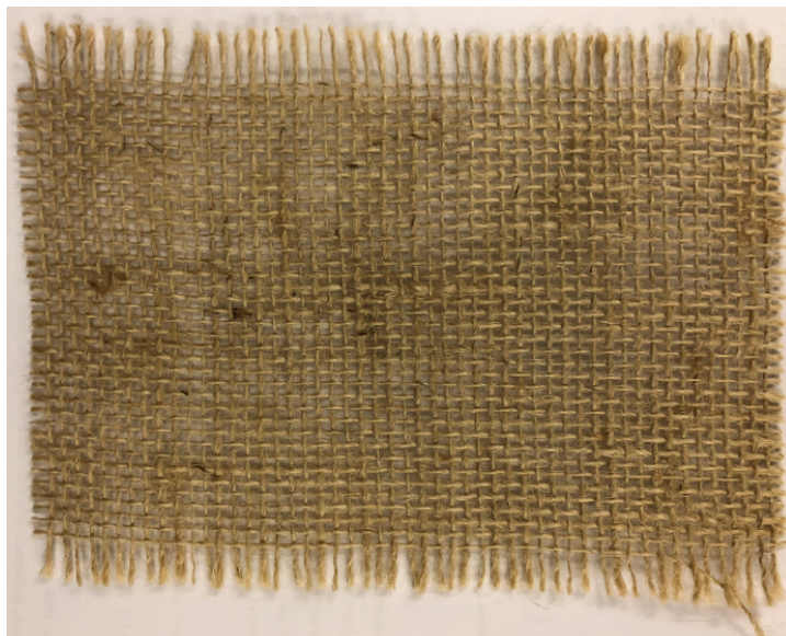
Figura 26 - Tecido de fibras de juta cortado no tamanho do molde 18,5 x 12,5 cm
