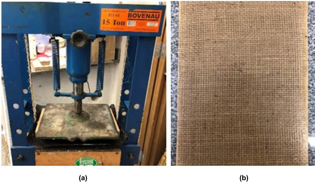
Figura 31 - (a) Prensagem/cura da amostra de compósito e (b) amostra do compósito de PU com tecido de juta
