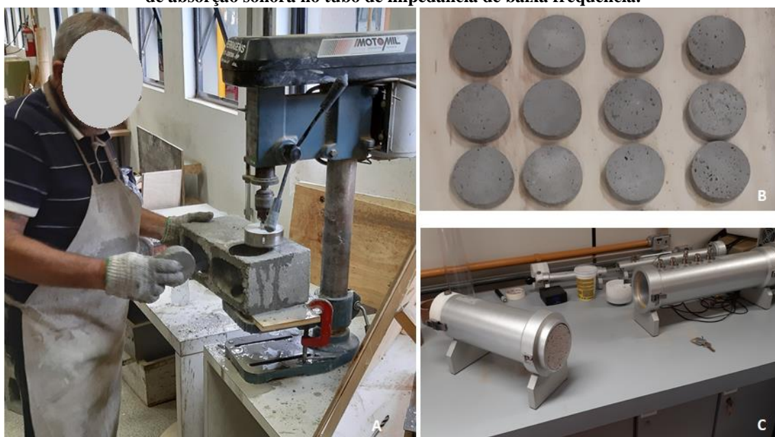
Figura 54 – Preparo das amostras de RCD para ensaio de absorção sonora no laboratório da PUCPR. A) Extração das amostras com serra copo. B) Amostras com Ø100 mm x 17 mm. C) Medição do coeficiente de absorção sonora no tubo de impedância de baixa frequência.
