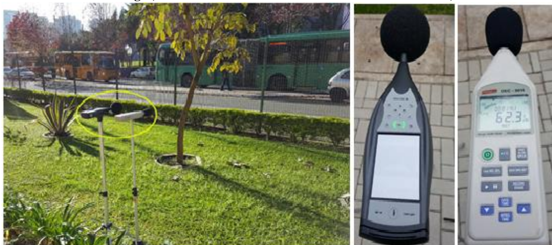
Figura 41 – Sonômetros utilizados para obter dados de níveis sonoros. Lado esquerdo: analisador modelo B&K 2250 Light, classe 1. Lado direito: analisador modelo DEC-5010, classe 2.
