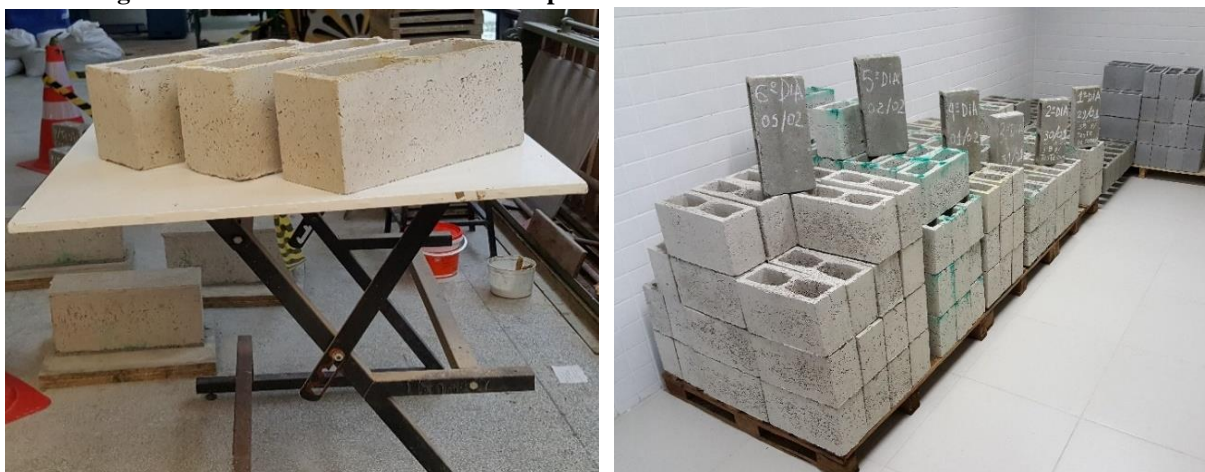
Figura 85 – Blocos de concreto de RCD produzidos no laboratório de materiais da UTFPR.
