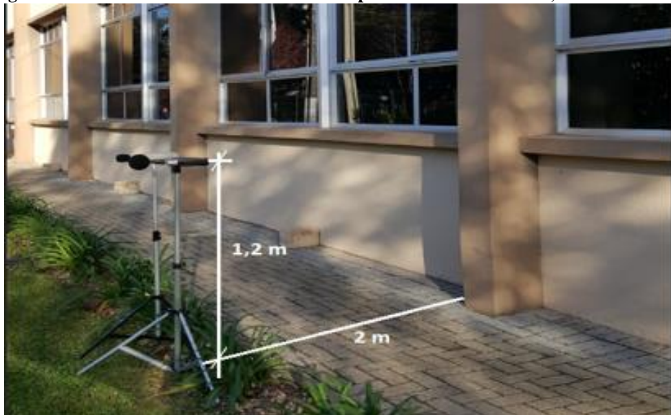
Figura 43 – Sonômetros afastados 2 metros da parede e com altura de 1,20 metro do solo.
