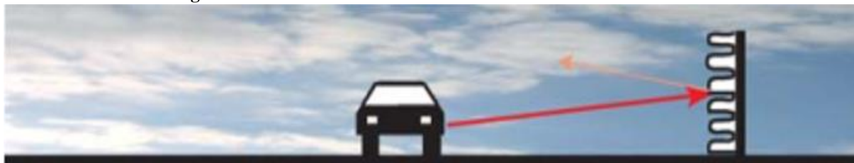
Figura 15 – Barreira acústica com material absorvente de ruído.
