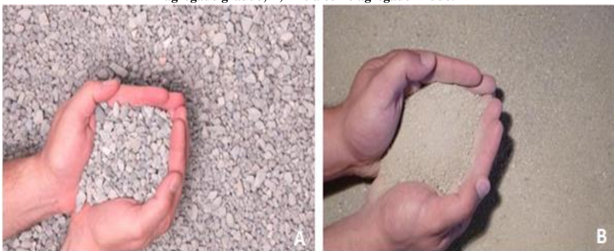
Figura 49 – Materiais reciclados utilizados na composição dos blocos de concreto. A) Pedrisco como agregado graúdo; B) Areia como agregado miúdo.
