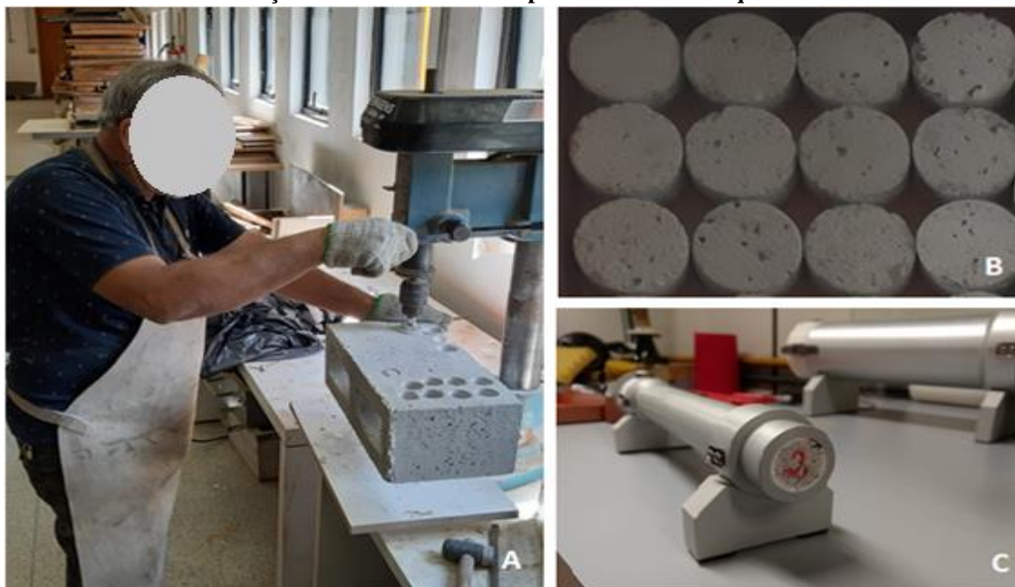
Figura 53 – Preparo das amostras de RCD para ensaio de absorção sonora no laboratório da PUCPR. A) Extração das amostras com serra copo. B) Amostras com Ø28 mm x 17 mm. C) Medição do coeficiente de absorção sonora no tubo de impedância de alta frequência.
