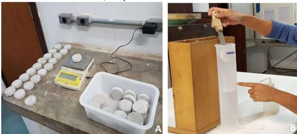
Figura 90 – Preparo das amostras para obter a massa específica. A) Pesagem das amostras. B) Medição do volume das amostras.
