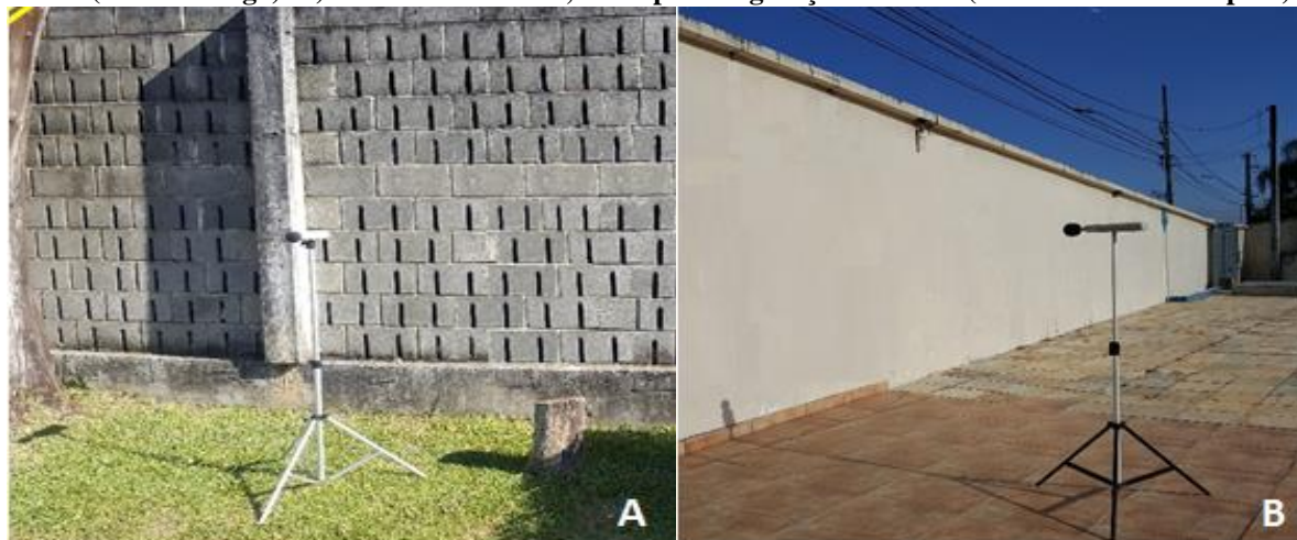
Figura 46 – Análise de desempenho de barreira acústica. A) Barreira acústica, face exposta à fonte de ruído (via de tráfego). B) Muro de alvenaria, face oposta à geração de ruído (lado voltado ao receptor).
