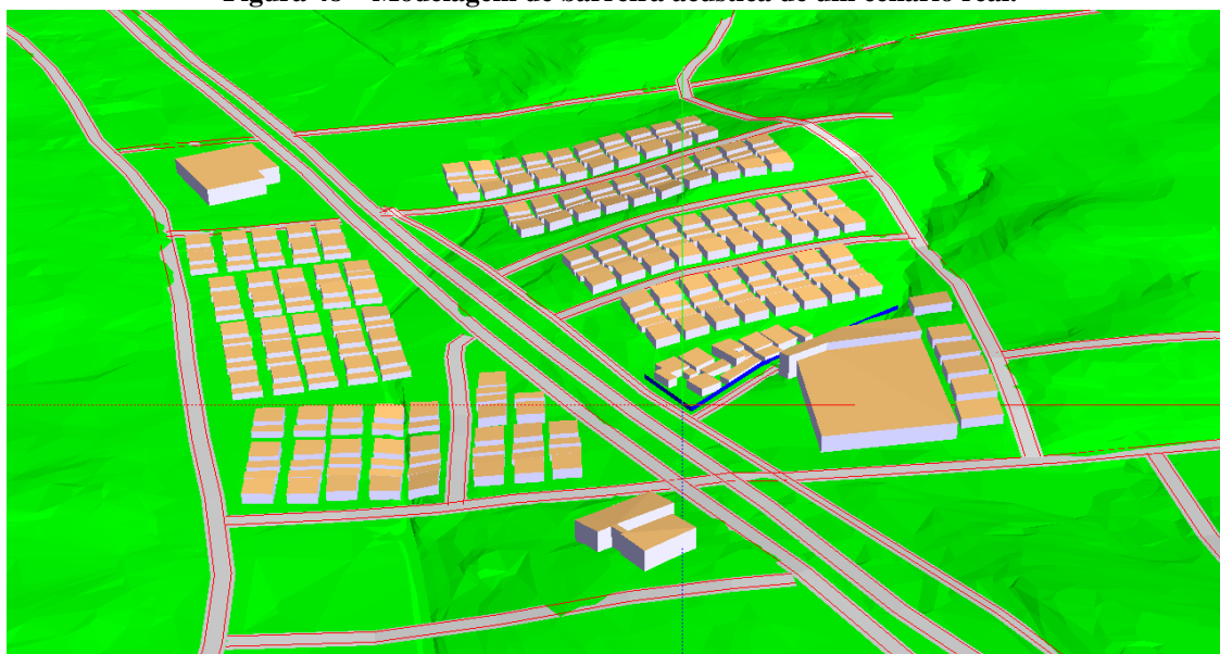
Figura 48 – Modelagem de barreira acústica de um cenário real.
