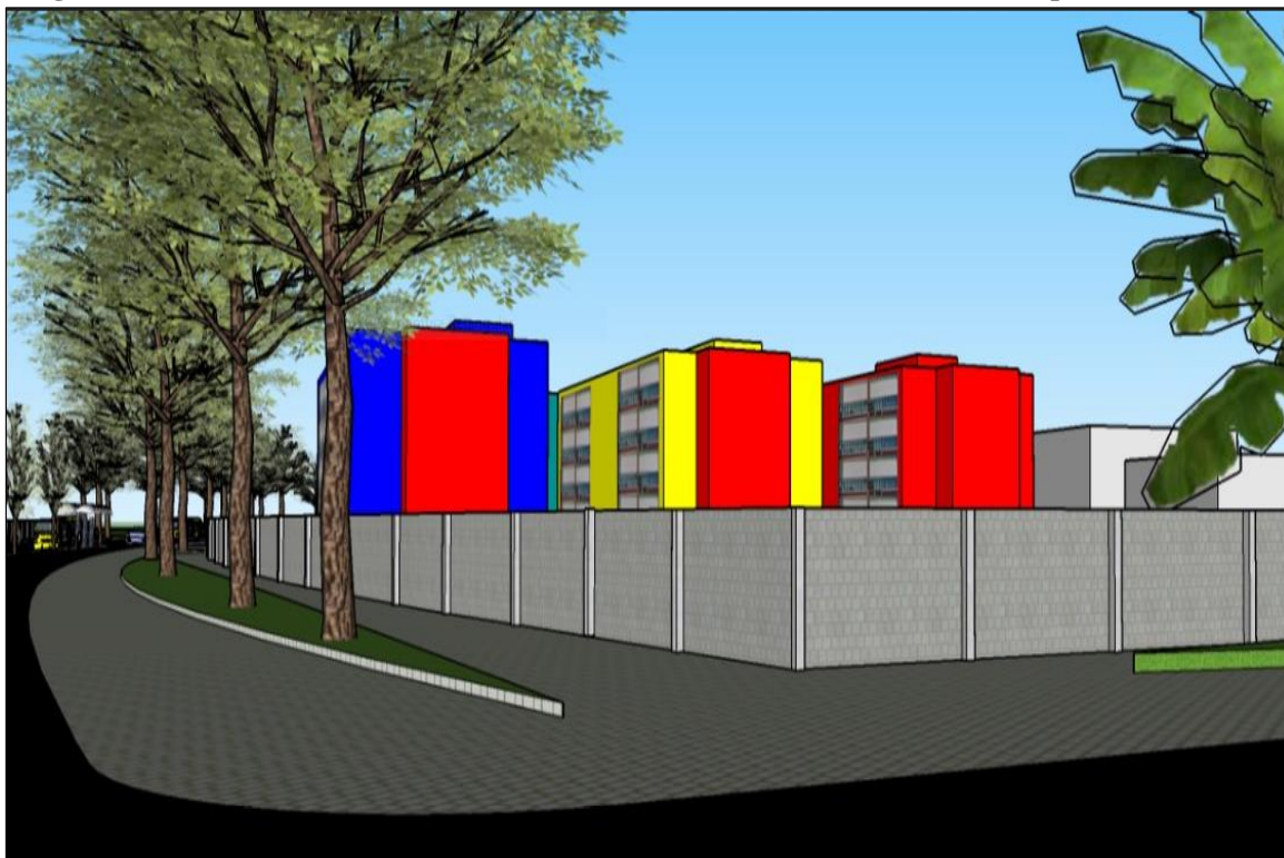
Figura 99 – Detalhe da barreira acústica de concreto de RCD das laterais do câmpus universitário.
