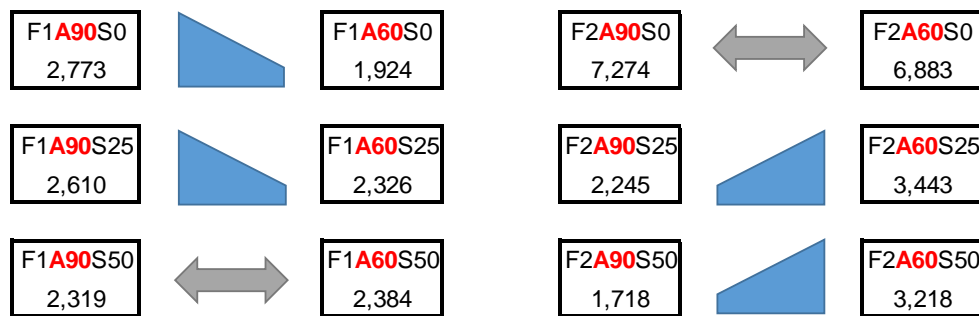
FIGURA 68 – DIAGRAMA DO REFLEXO NA PERMEABILIDADE k_1 ÀS VARIAÇÕES DO ÂNGULO DE RASTER
