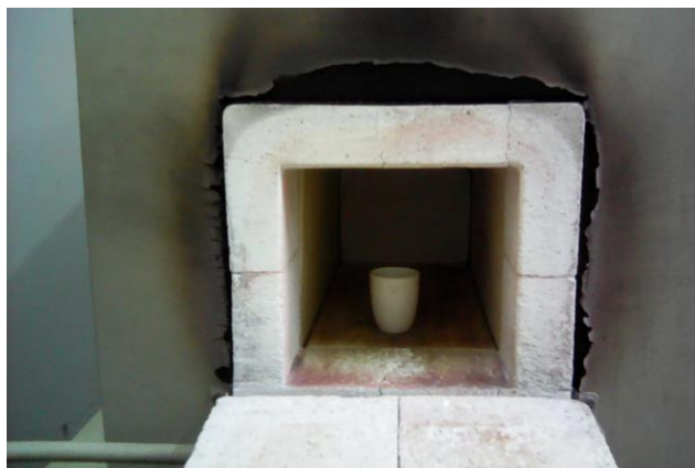
Figura 14 - Cadinho de porcelana utilizado na calcinação.
