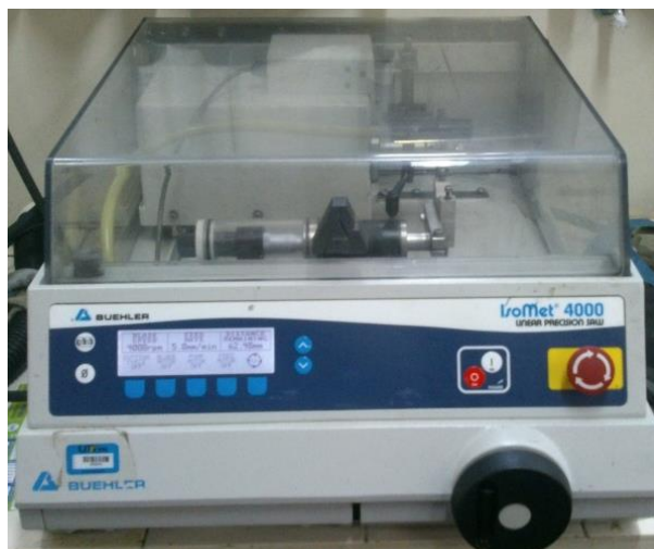
Figura 25 - Cortadeira de precisão Buehler Isomet 4000
