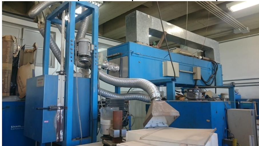
Figura 38 – Equipamento utilizado para a realização dos testes de resistência à erosão por colisão de partículas em altas temperaturas
