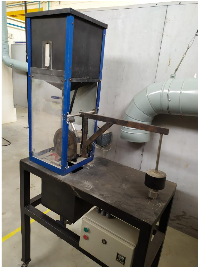
Figura 35 - Equipamento baseado no descrito pela norma ASTM G65 utilizado nos testes de resistência a abrasão por roda de borracha
