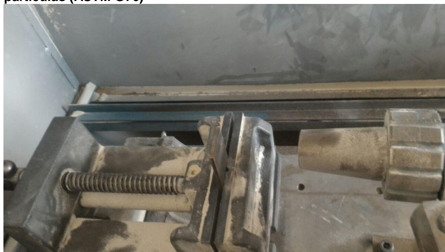
Figura 36 - Aparato utilizado nos ensaios de desgaste por colisão de partículas (ASTM G76)
