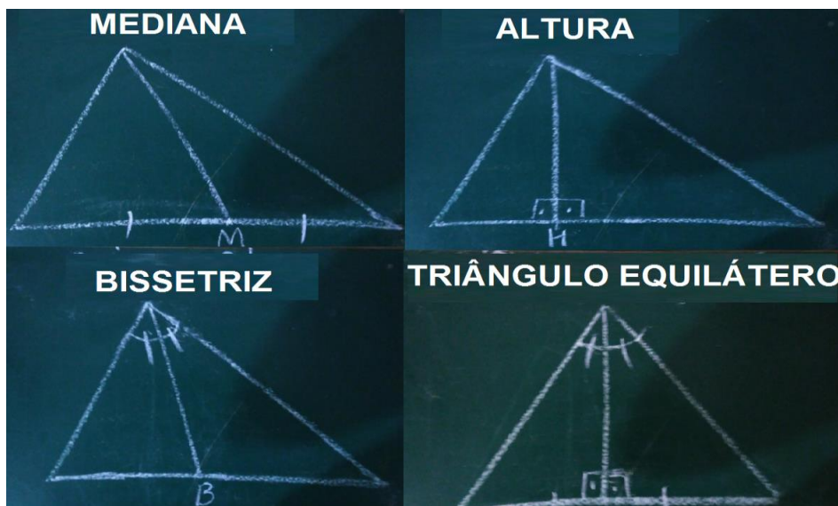
Figura 56 _ Principais cevianas dos triângulos
