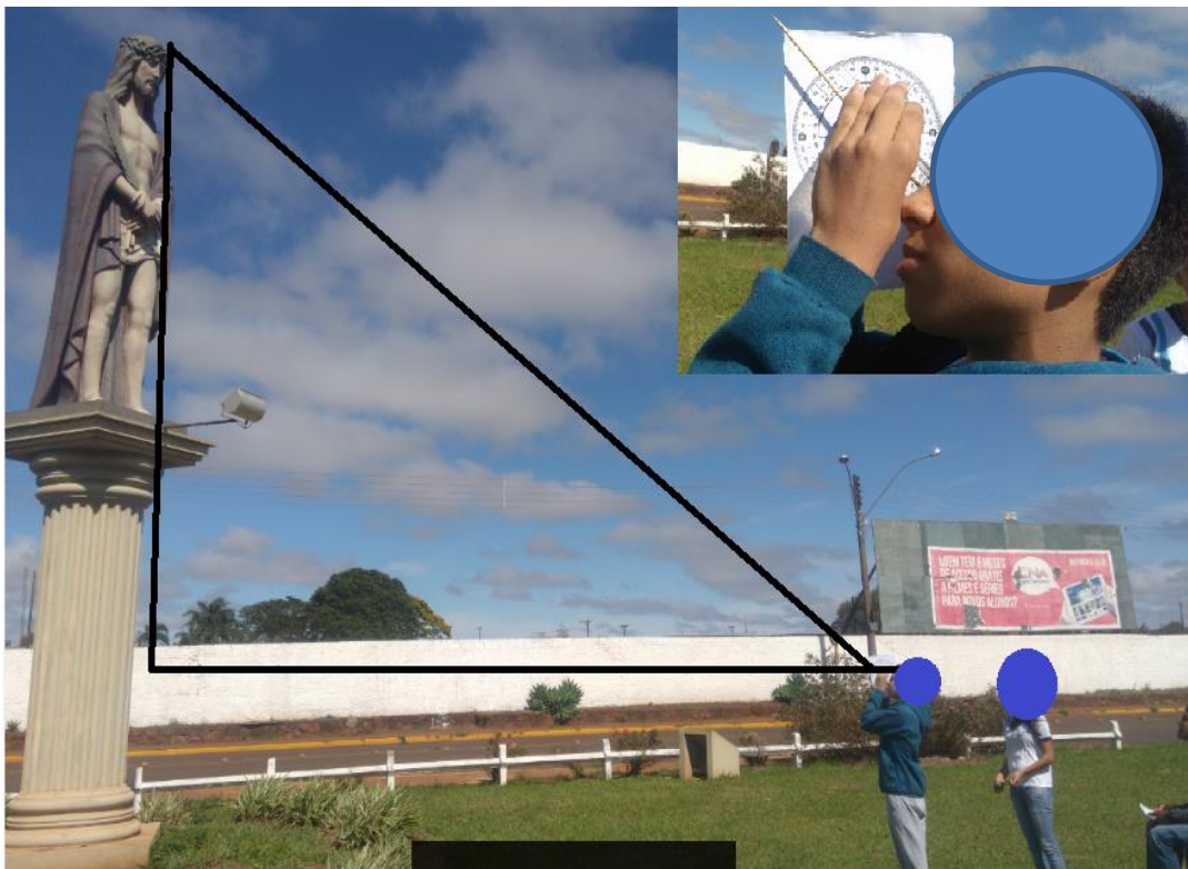
Figura 93 _ Uso do teodolito caseiro para cálculo da altura da estua do padroeiro da cidade.
