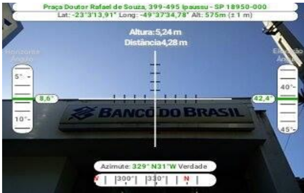
Figura 108 _ Altura do prédio do banco do Brasil com o aplicativo Theodolite Dróid.
