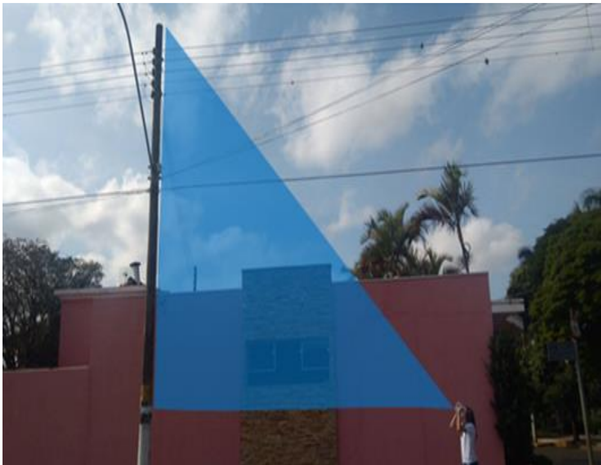
Figura 97 _ Uso do teodolito caseiro para cálculo da altura do poste
