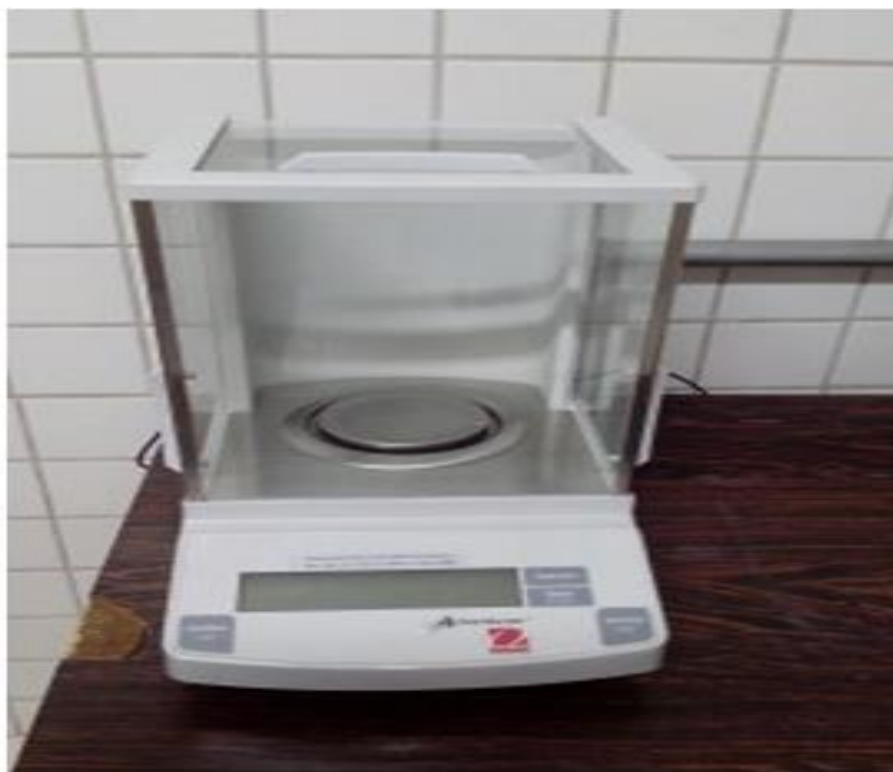
Figura 17-Balança marca Toledo do Brasil Industria de Balança Ltda, modelo Ohaus Analíticas série Adventurer com capacidade de 210g e erro de 0,001. Fonte: Autoria própria.
