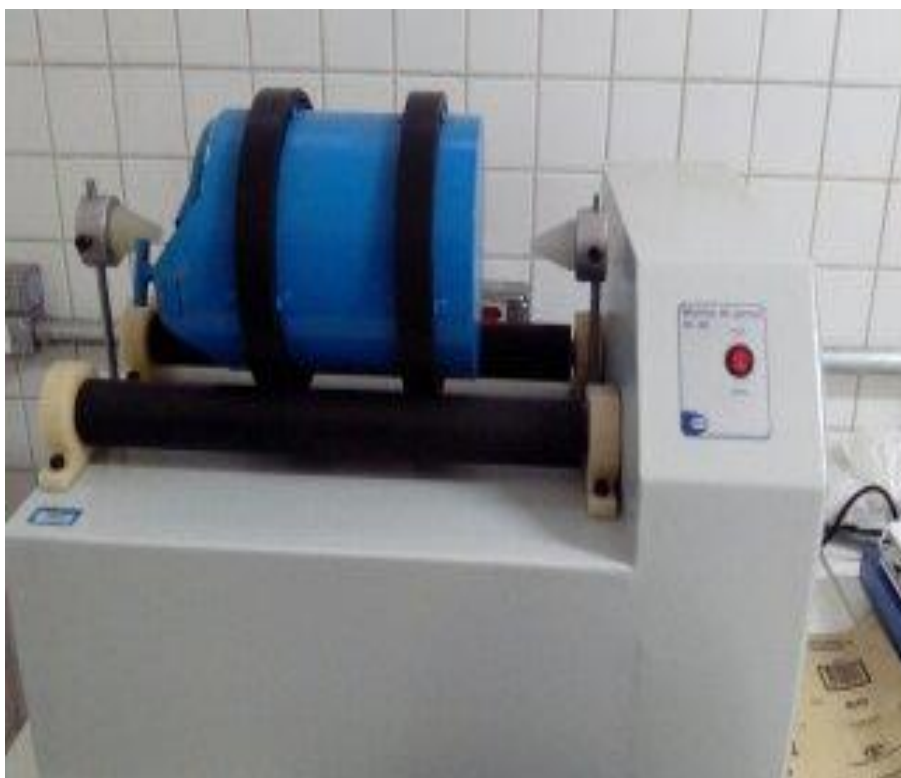
Figura 18-Moinho de jarro modelo SL-34/2-RF fabricante Solab Equipamentos para Laboratórios. Fonte: Autoria própria.
