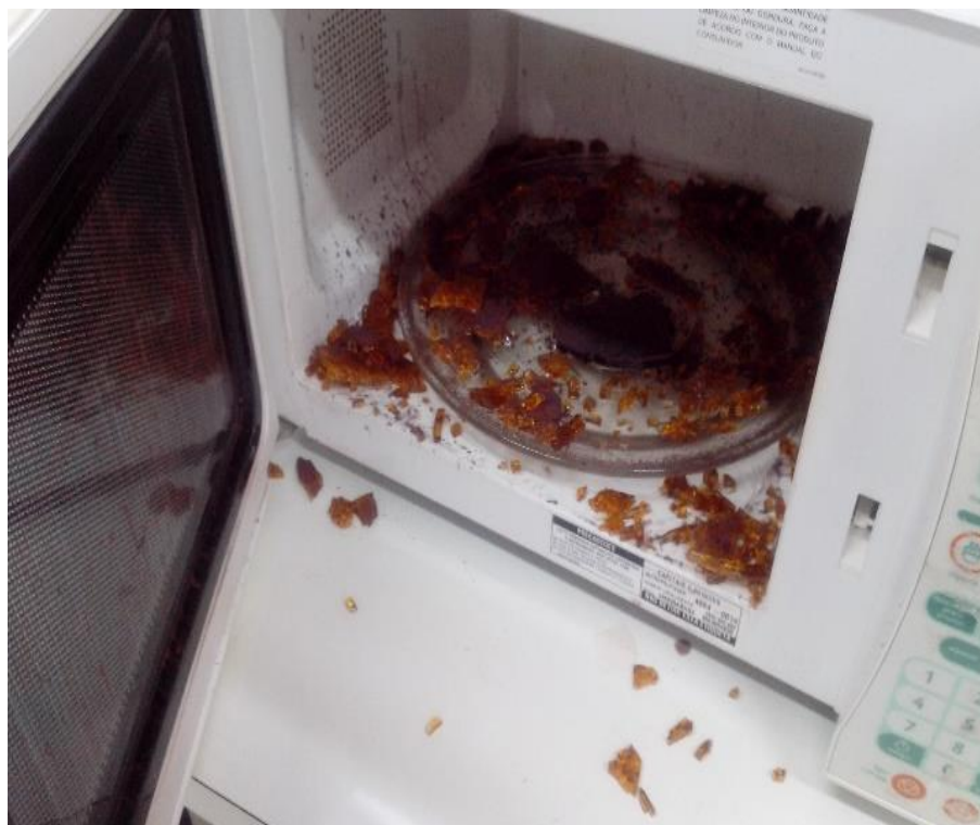
Figura 19-Explosão em virtude de superaquecimento da amostra. Fonte: Autoria própria.
