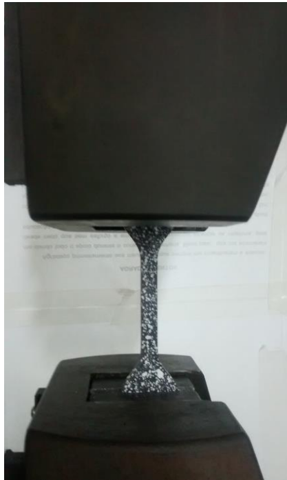
Figura 7 – Disposição do corpo de prova na pinça de tração.
