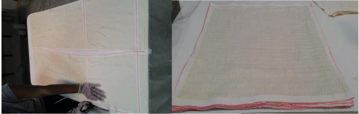
Figura 17 – Corte das lâminas de FA. Fonte: Autoria própria.
