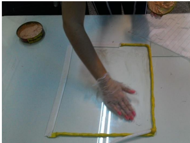
Figura 18 – Delimitação e lubrificação da área de moldagem. Fonte: Autoria própria.
