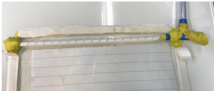
Figura 20 – Fixação da conexão T e do espiral. Fonte: Autoria própria.
