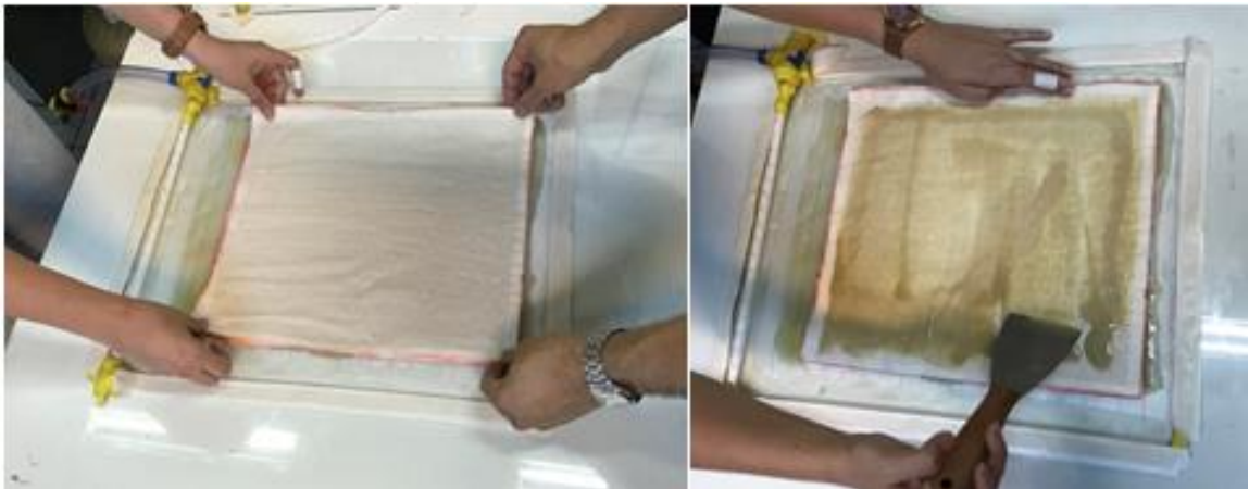
Figura 23 – Posicionamento da segunda metade das lâminas de FA e PU vertida acima das mesmas.
