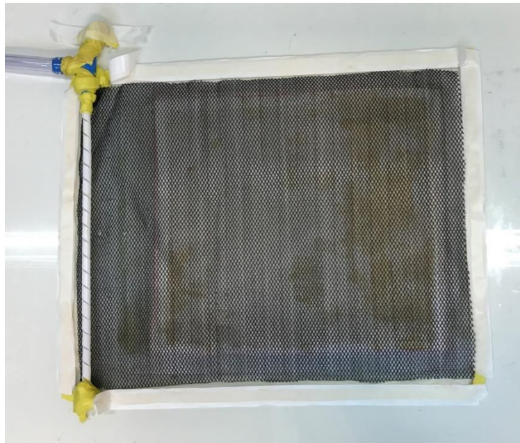
Figura 25 – Posicionamento da tela distribuidora de resina. Fonte: Autoria própria.
