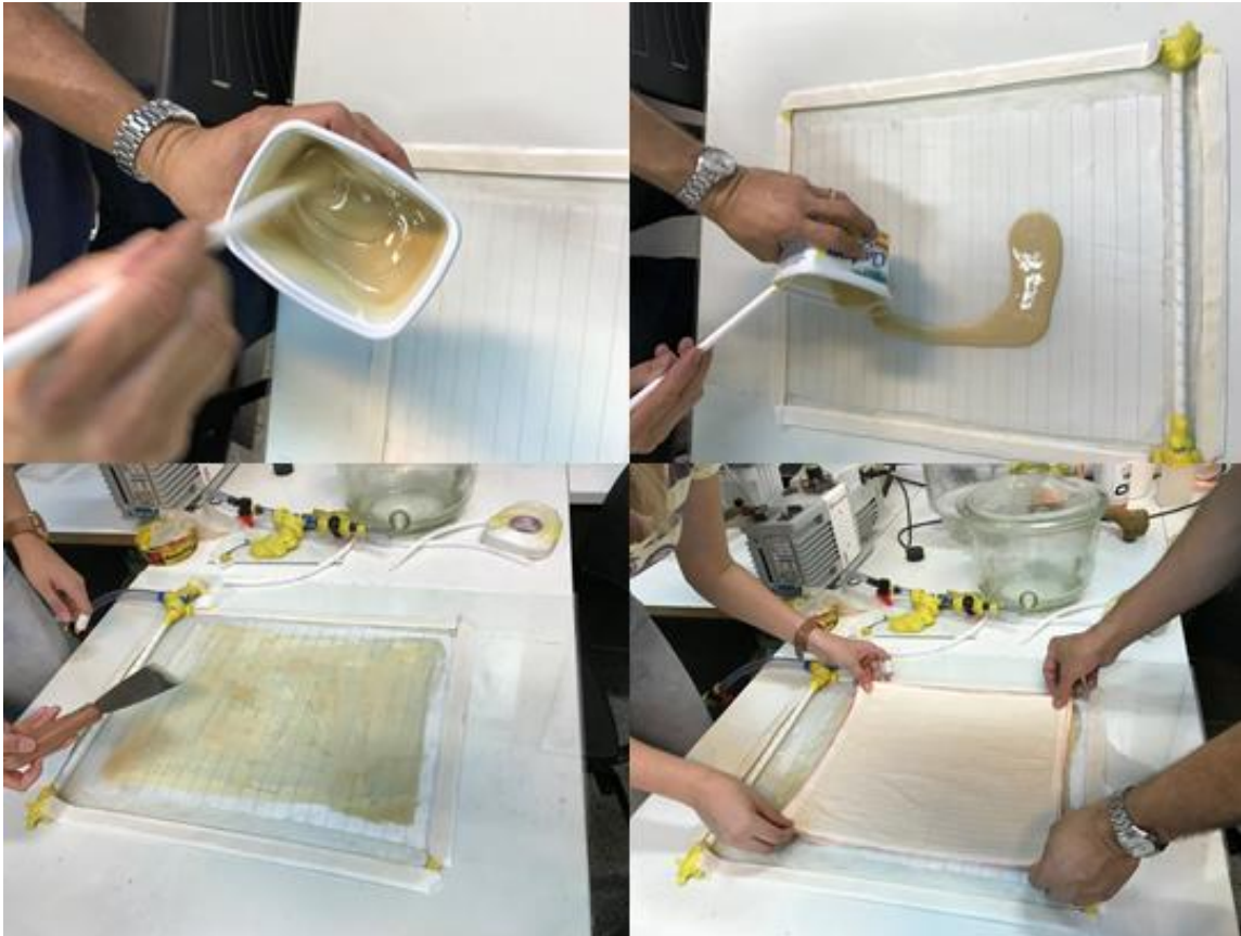
Figura 21 – PU vertida na primeira camada de Peel Ply e posicionamento das primeiras lâminas de FA.
