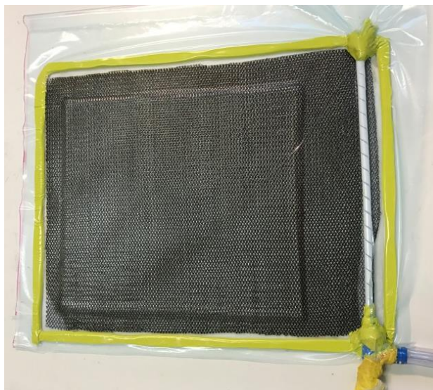
Figura 27 – Acionamento da bomba de vácuo. Fonte: Autoria própria.
