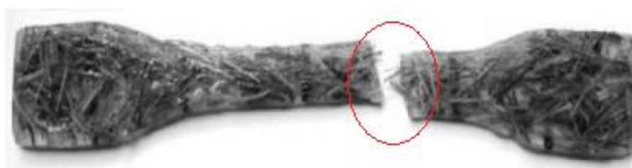
Figura 3 – Corpo de prova fraturado do biocompósito de poliéster reforçados por fibra da folha de licuri com presença de pull-out . Fonte: SANTOS et al., 2015.
