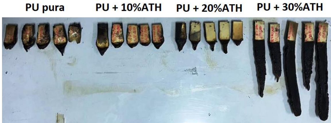
Figura 39 - Corpos de prova após a realização do ensaio de inflamabilidade na vertical. Fonte: Autoria própria
