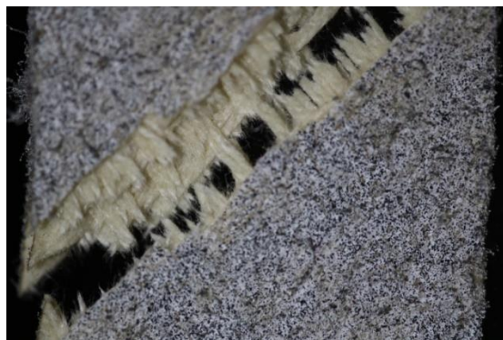
Figura 51 – Corpo de prova fraturado do compósito de PU+7FA com orientação a \pm 45^\circ . Fonte: Autoria própria.
