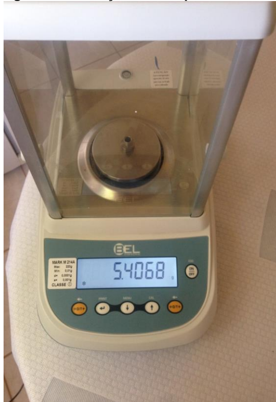
Figura 19: Balança utilizada para medir as massas das peças.
