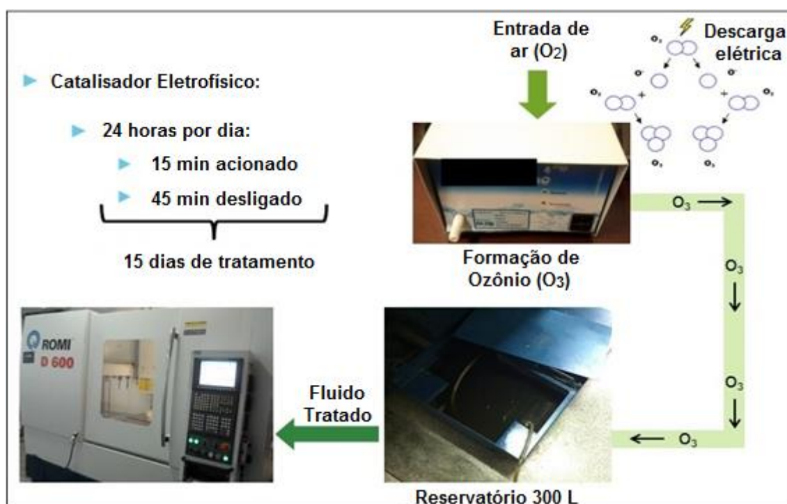
Figura 4 – Esquema de tratamento com catalisador eletrofísico Fonte: Autoria própria.
