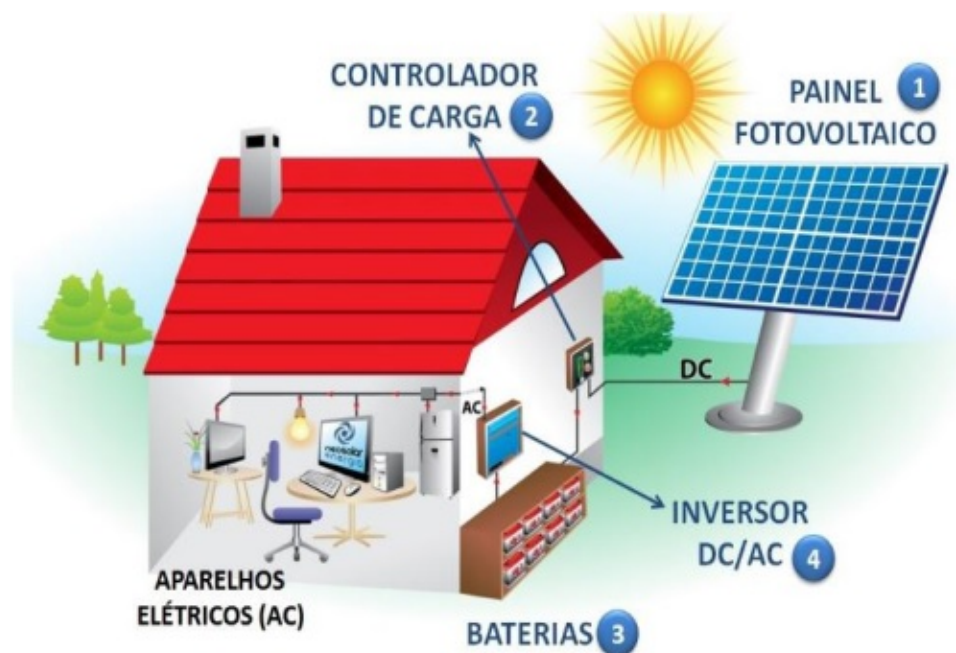
Figura 6: Sistema Fotovoltaico isolado
