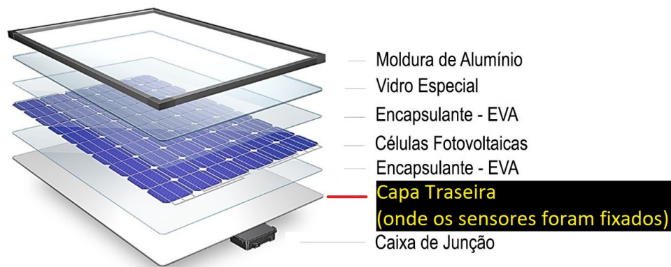
Figura 40: Camadas que compõem um módulo fotovoltaico
