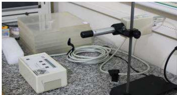
Figura 15 - Imagem da Câmara de ionização e eletrômetro
