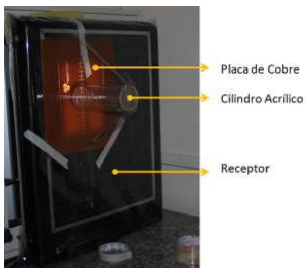
Figura 12 - Equipamento utilizado para teste de colimação e alinhamento do feixe indicando a posição da placa de cobre, cilindro e receptor.
