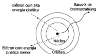
Figura 4 - Ilustração da emissão de raios X de bremsstrahlung (ROS, 2000)
