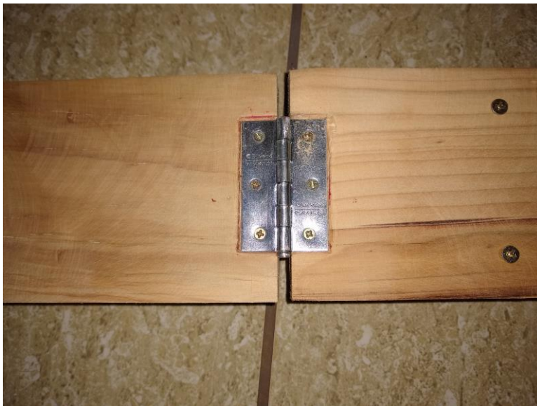
Figura 7 - Sistema de acoplamento das tábuas para plano inclinado.
