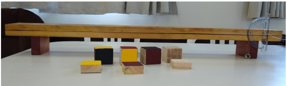
Figura 9 - Atividade experimental para obtenção dos ângulos críticos.
