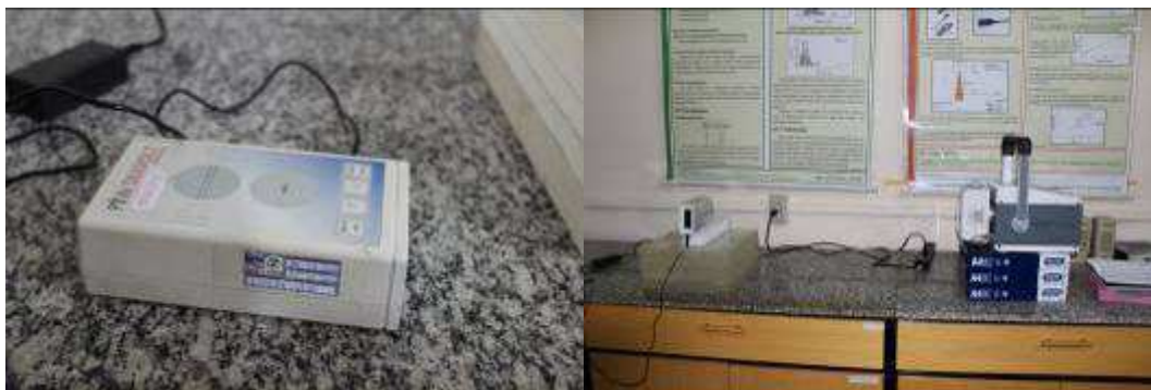
Figura 13 – Aparelho PTW Diavolt e Posicionamento do mesmo em relação ao aparelho emissor de raios X
