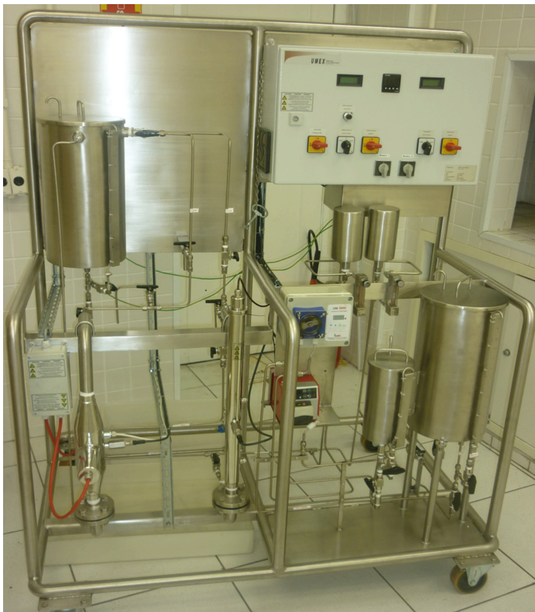
Figura 6. Fotografia do sistema de tratamento avançado de água com reatores UV, operados com lâmpadas de baixa e média pressão. Fonte: autoria própria (2012).
