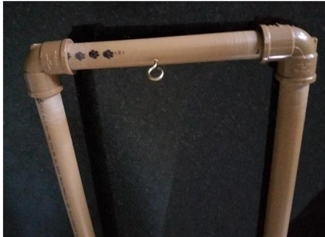
Figura 19: Montagem de uma extremidade do trilho
