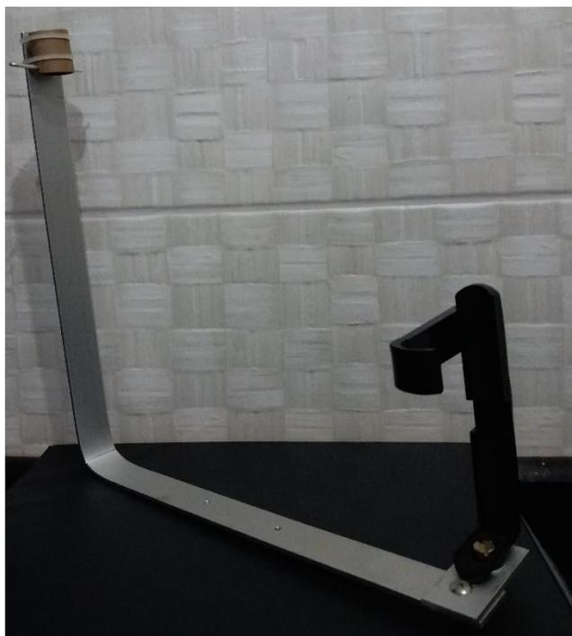
Figura 16: Sistema para filmagem e sistema mecânico para soltar a esfera
