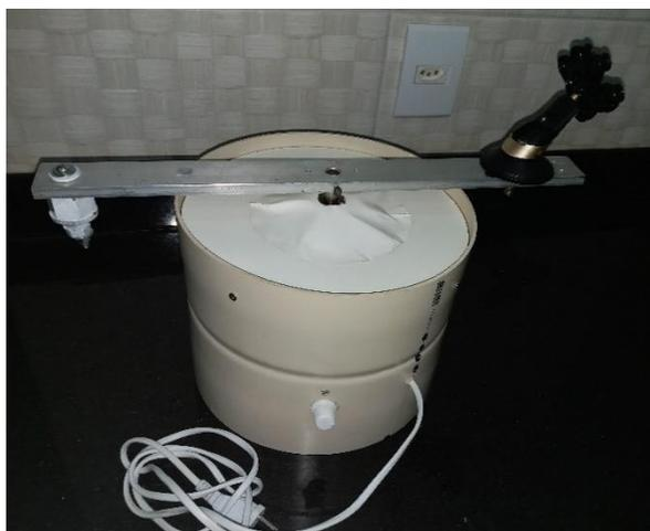
Figura 5: Plataforma giratória com régua de alumínio, suporte de celular e contrapeso
