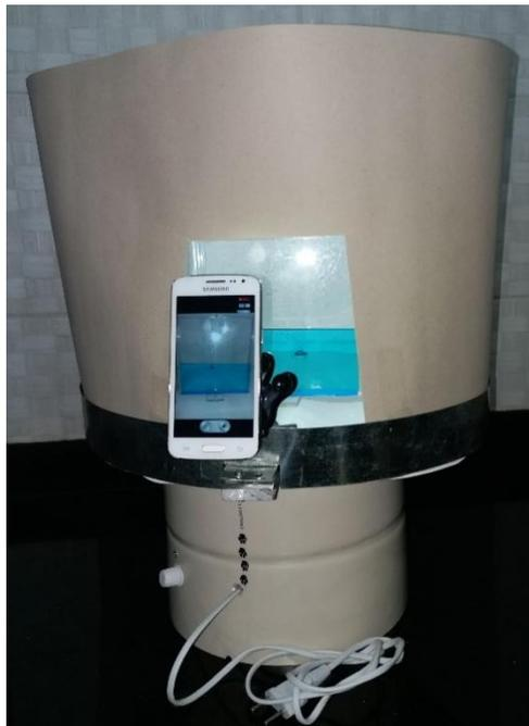
Figura 10: Experimento 1: Balde de Newton em plataforma giratória concluído
