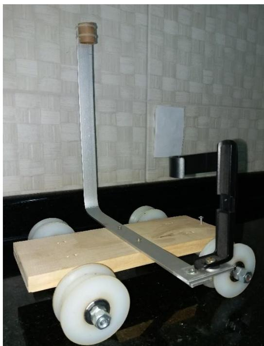
Figura 17: Montagem do carrinho com sistema para filmagem e sistema mecânico para soltar a esfera concluída
