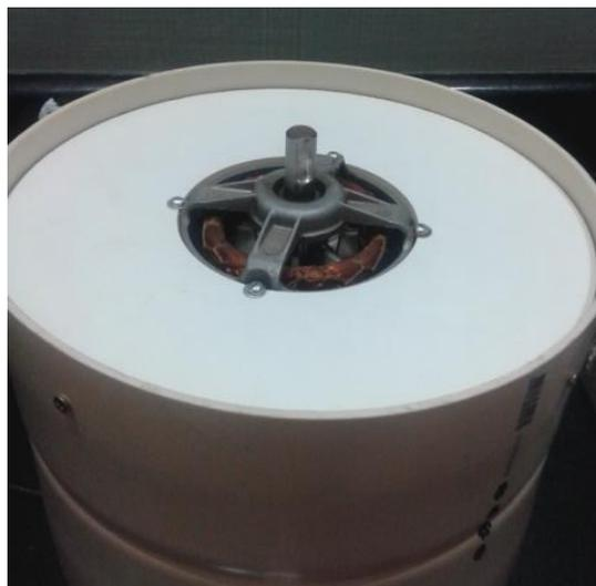
Figura 2: Fixação do disco de mdf na luva de cano pvc
