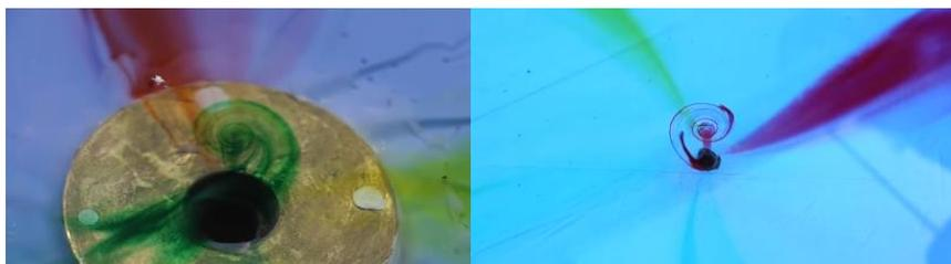
Figura 28: Movimento da água em uma piscina com abertura no fundo
