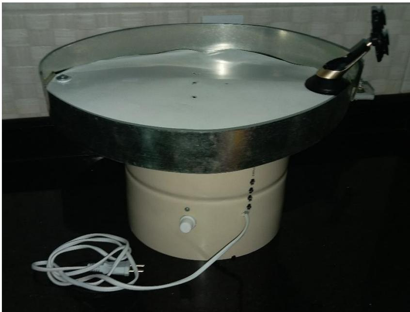
Figura 7: Papel cartão fixado na lâmina de galvanizado
