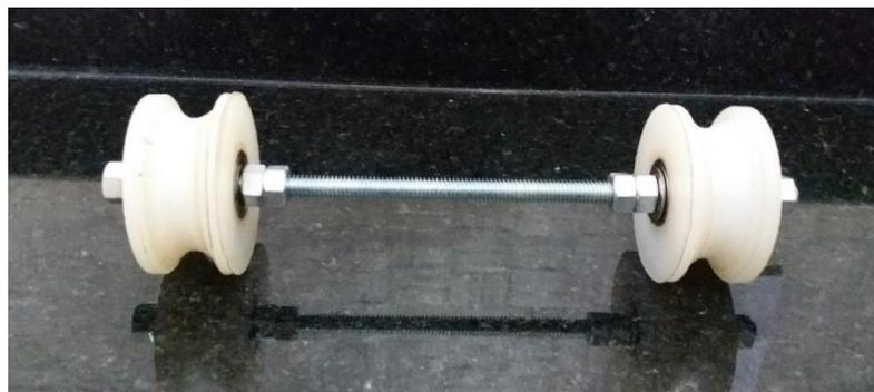
Figura 13: Montagem dos eixos do carrinho
