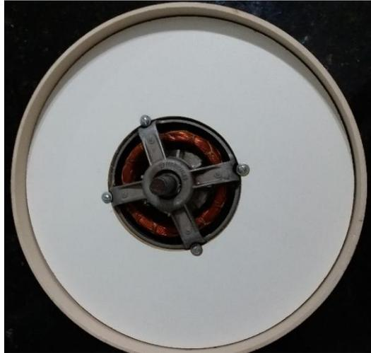
Figura 1: Fixação do motor no disco de mdf
