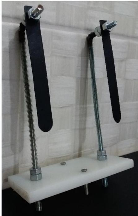
Figura 11: Montagem do suporte com dois pêndulos
