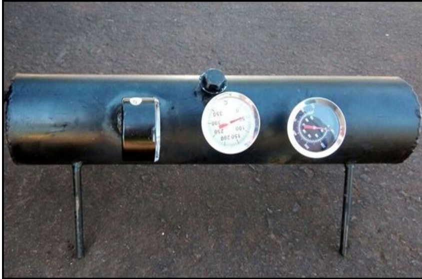
Figura 33 – Acoplagem do termômetro e manômetro ao cilindro
