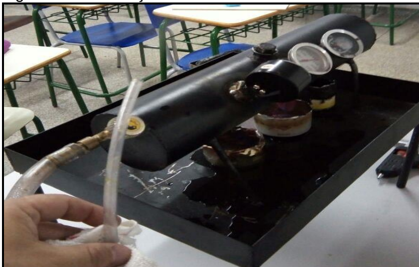
Figura 35 – Colocação do cilindro sobre a base
