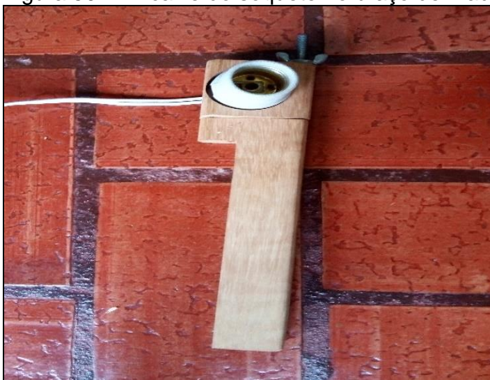
Figura 50 – Encaixe do soquete no braço de madeira
