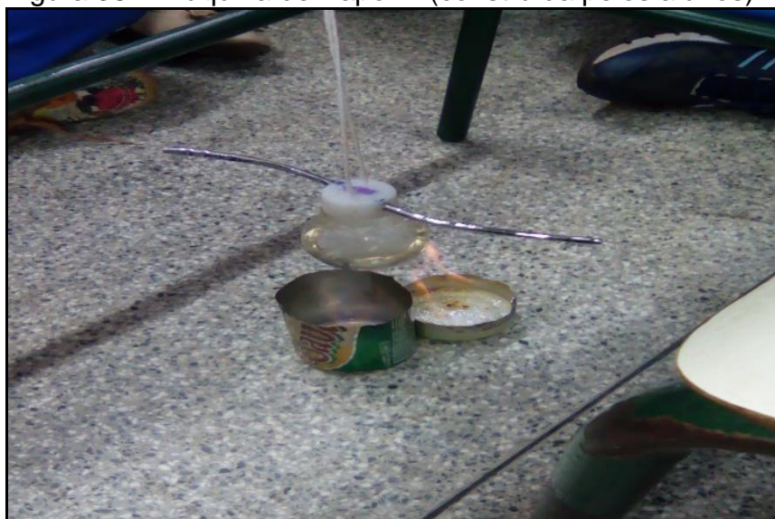
Figura 38 – Máquina de Vapor 2 (construída pelos alunos)
