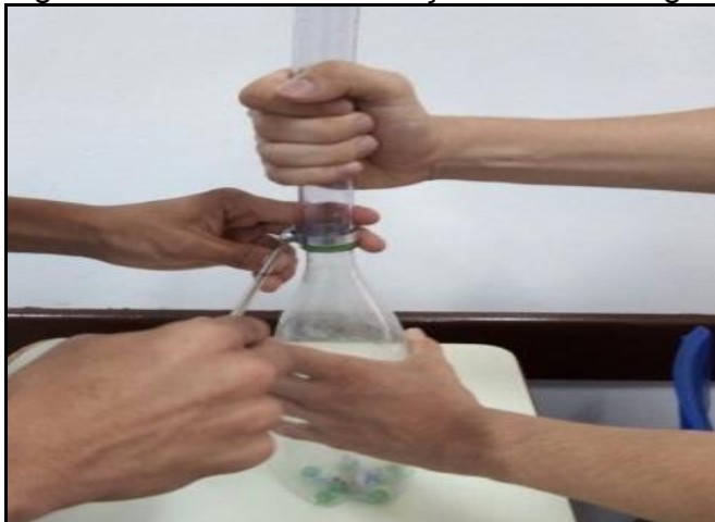
Figura 46 – Encaixe da braçadeira na mangueira
