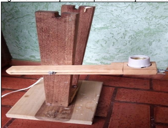
Figura 52 – Fixação do soquete no braço de madeira
