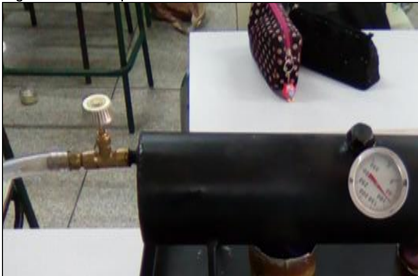
Figura 34 – Rosqueamento da válvula ao cilindro
