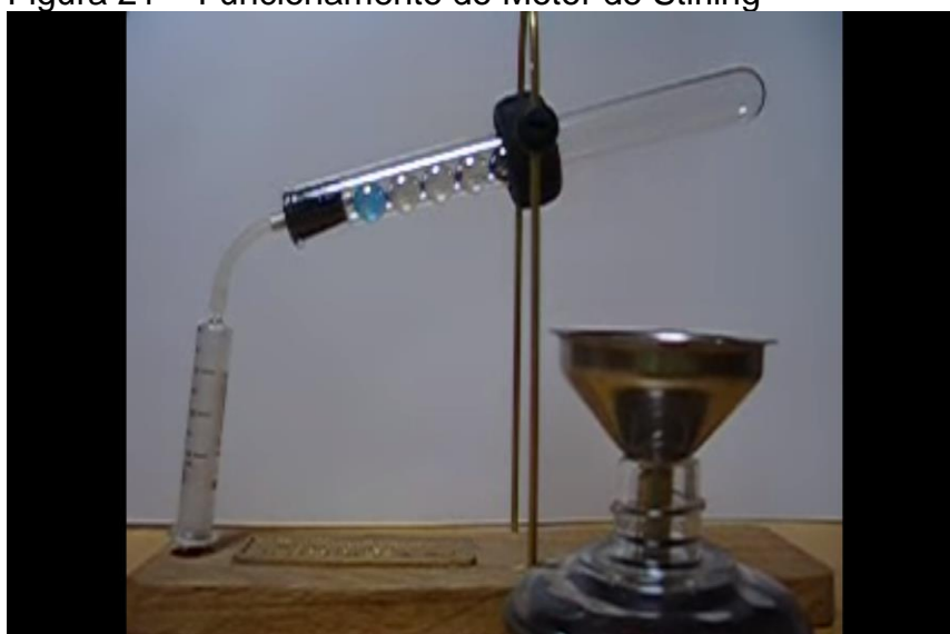
Figura 21 – Funcionamento do Motor de Stirling
