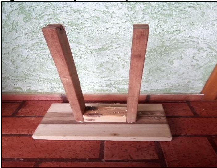
Figura 51 – Fixação dos braços de madeira na base
