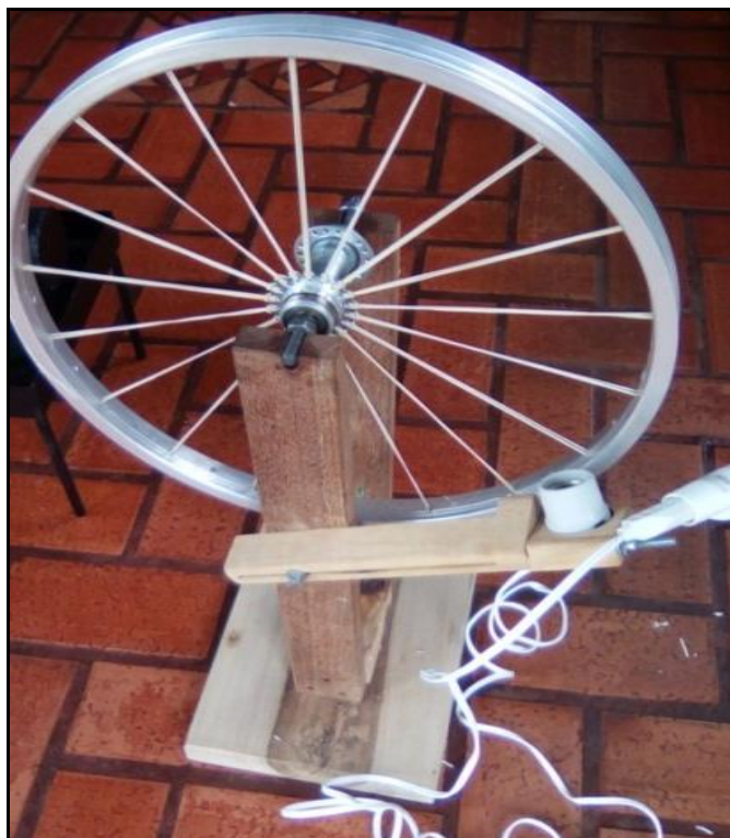
Figura 55 – Junção do sistema à base de madeira
