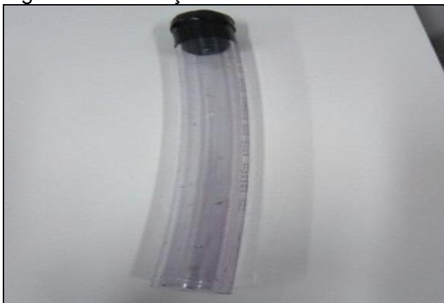
Figura 44 – Vedação da extremidade da mangueira
