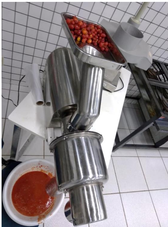
Figura 6 – Despoldadeira mecânica, modelo DTP-50 (Tomasi). Foto do autor. 2019.
