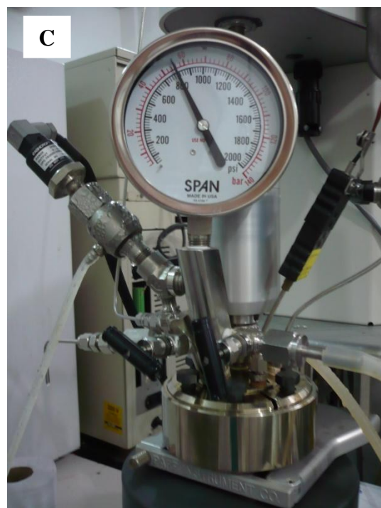
Figura 18 - Unidade de reação de hidrocraqueamento/hidroconversão de n-hexadecano: A) Vista da unidade completa operando; B) reator e cilindro de hidrogênio acoplado na parte de trás do módulo; C) detalhes do reator, manômetro e conexões.
