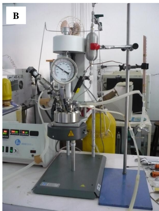
Figura 18 - Unidade de reação de hidrocraqueamento/hidroconversão de n-hexadecano: A) Vista da unidade completa operando; B) reator e cilindro de hidrogênio acoplado na parte de trás do módulo; C) detalhes do reator, manômetro e conexões.
