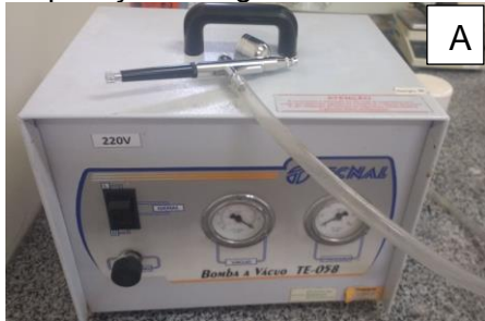
Figura 2 - A) Bomba de pressão utilizada para pulverização das soluções dos óleos essenciais de E. uniflora e P. cablin ; B) Placas de petri dispostas em câmara de fluxo laminar horizontal para evaporação da água.
