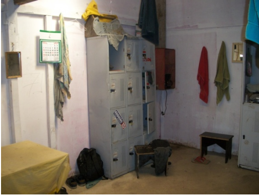
Figura 52 - Vestiário com problemas de ventilação, limpeza e falta de bancos - Obra B. Fonte: O autor (2016)
