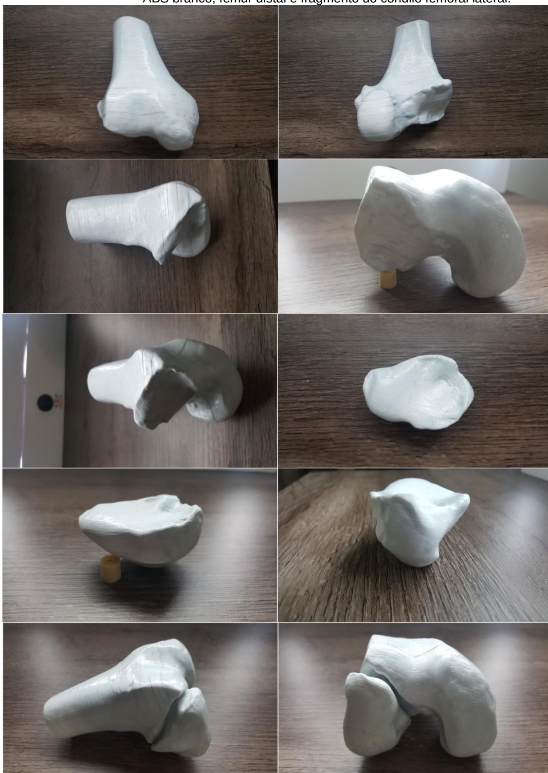
Foto 2 - Imagens do modelo ósseo impresso em 3D com a tecnologia FDM em ABS branco, fêmur distal e fragmento do côndilo femoral lateral.
