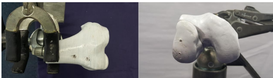
Foto 6 - Imagens após fixação com dois parafusos de pequenos fragmentos.
