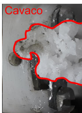
Figura 44 – Cavaco encrustado na ponta da ferramenta de corte.
