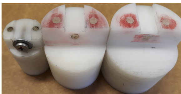
Figura 36 – Suportes fabricados em poliacetal utilizados para fixação das ferramentas de cortes.
