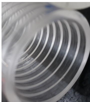
Figura 38 – Tubo corrugado após o processo de usinagem.
