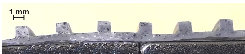
Figura 40 – Reprodução (molde) do formato das cavidades usinadas nos tubos corrugados para verificação da forma geométrica da cavidade.
