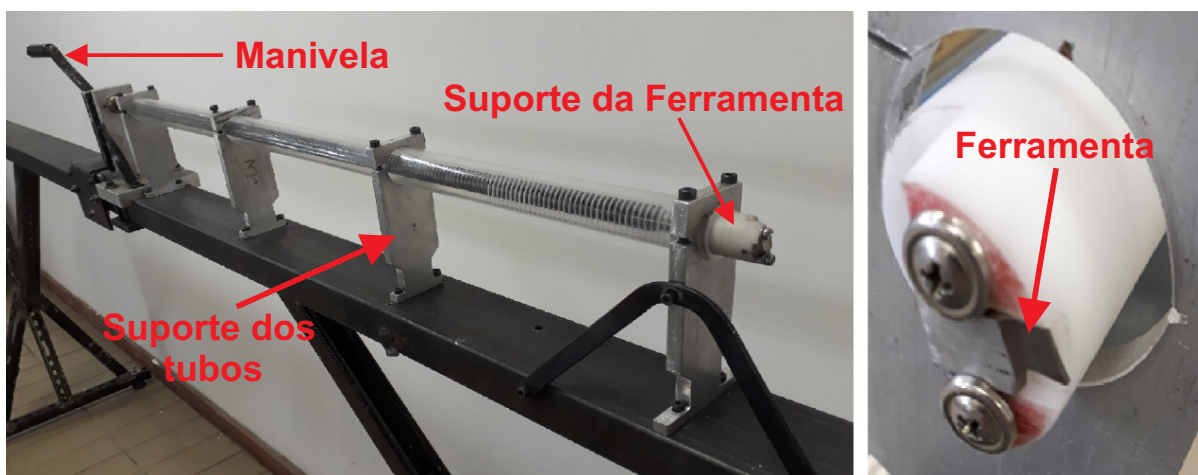
Figura 34 – Aparato de usinagem utilizado para fabricação dos tubos corrugados.
