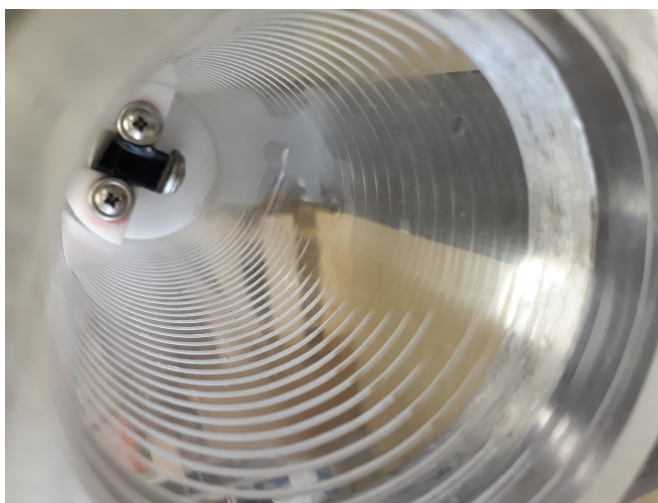
Figura 41 – Processo de usinagem de um tubo de acrílico extrudado com não uniformidade devido à grande variação de espessura de parede.
