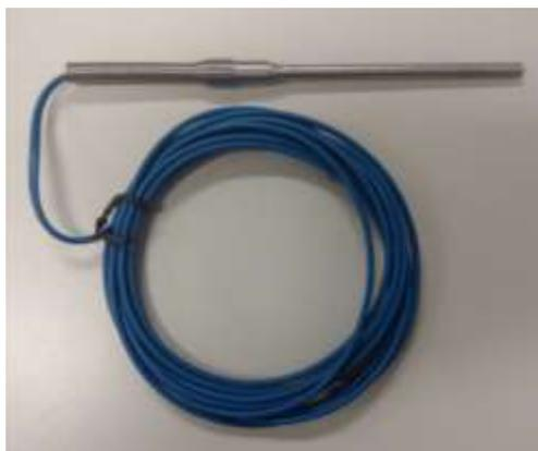
Figura 3.9 – Termopar do tipo T modelo TIM11.
