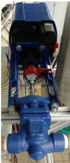
Figura 3.5 – Válvula de controle com atuador elétrico ARI-PREMIO Plus 2G.
