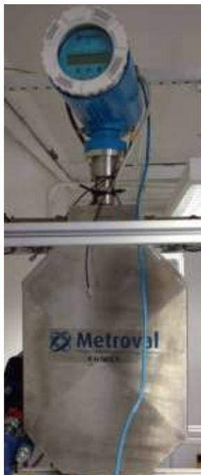
Figura 3.12 - medidor de vazão mássica do tipo coriolis.
