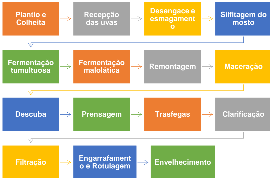
Figura 2: Fluxograma do processo de vinificação
