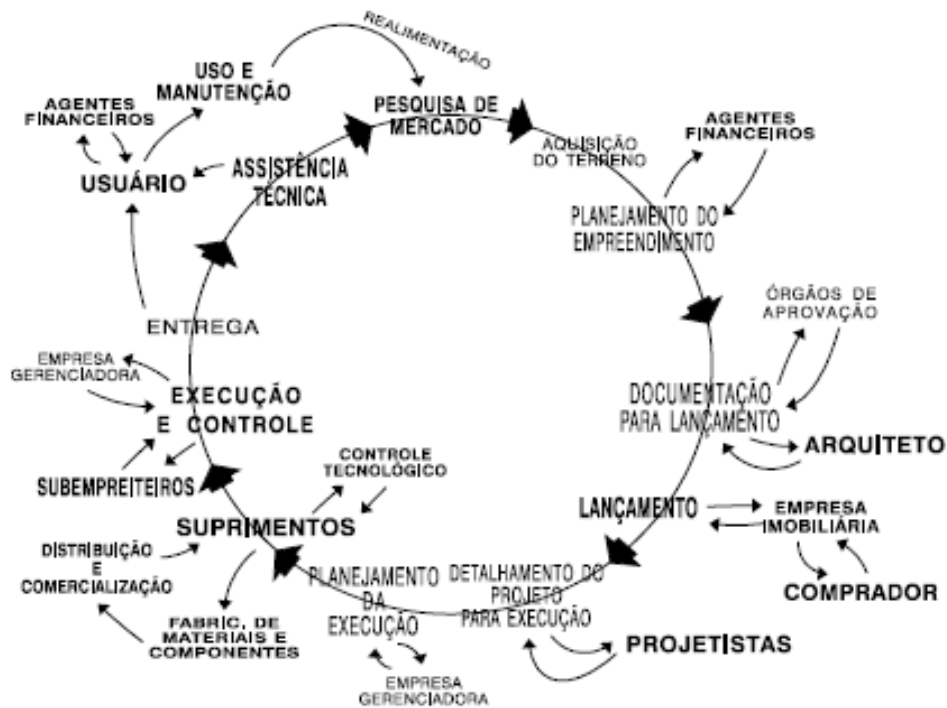
Figura 7 – O ciclo da qualidade em empresas de incorporação e construção segundo Picchi e Agopyan
