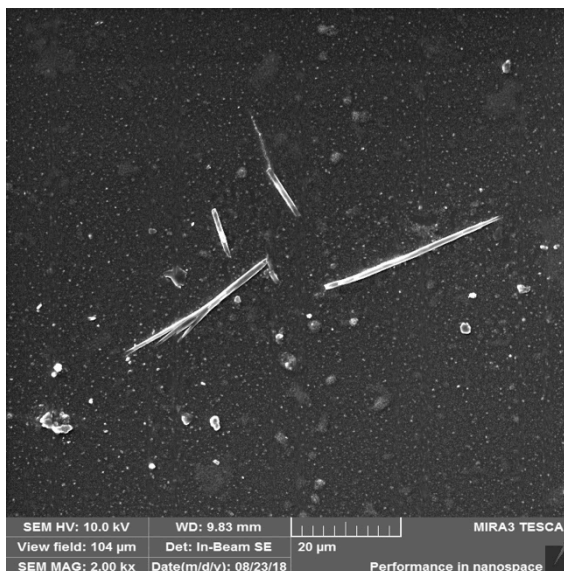
Figura 69: Imagens de MEV de estruturas de ouro bulk em AAT- \text{Au}_4\text{AP}_{10}(50)/\text{NTCU}_F . Fonte: Autoria própria (2019).
