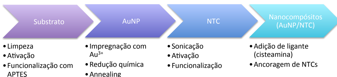
Figura 17: Resumo das etapas de síntese para a preparação dos nanomateriais para a síntese dos nanocompósitos de AuNP/NTC.
