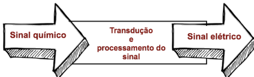
Figura 10: Esquema simplificado de um sensor químico. Fonte: Autoria própria (2019).
