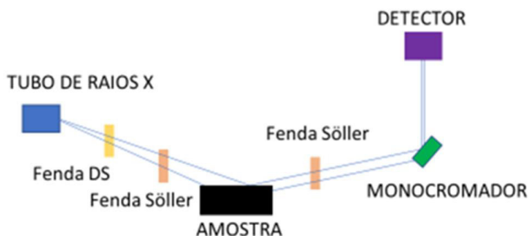
Figura 9 - Esquema exemplificando o funcionamento do difratômetro.
