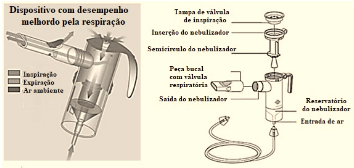
Figura 10 - Esquema do nebulizador que utiliza rede vibratória.
