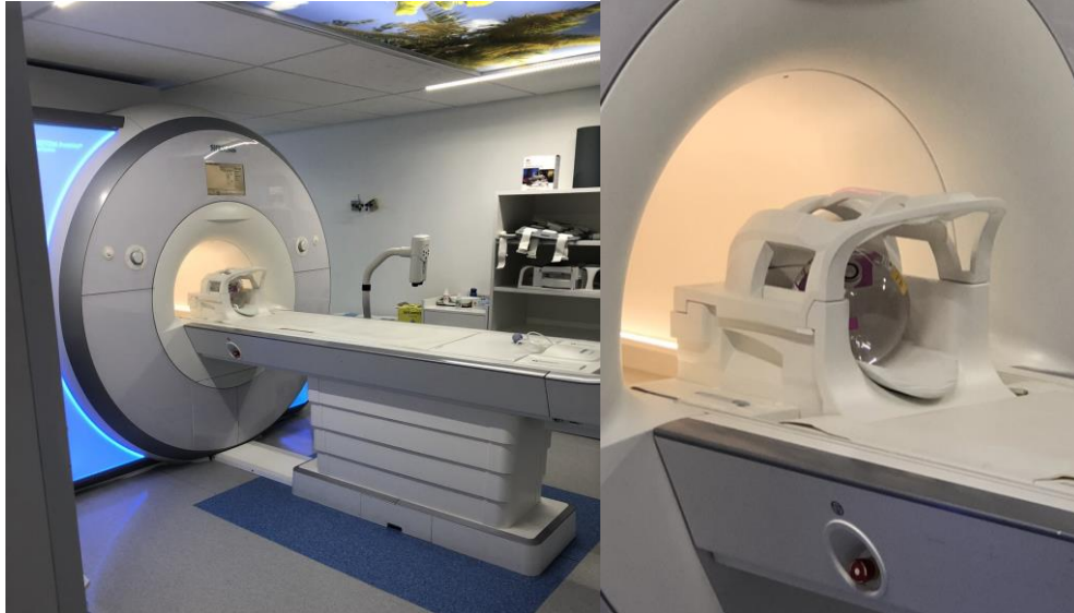
Figura 11- Posicionamento do phantom dentro da bobina matrix, vista da porta da sala de exame
