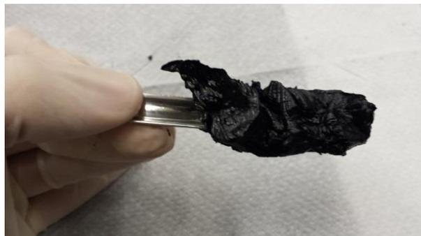
Figura 1.3 – Petróleo parafínico gelificado em temperatura abaixo à de cristalização.
