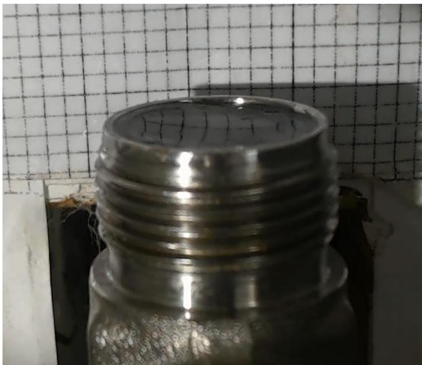
Figura 4.2 – Abertura da conexão tipo “T” com o plano de referência ao fundo, mostrando o nível de Carbopol®, fotografado pela câmera.
