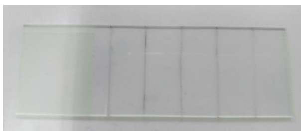
Figura 78 – Lâmina de vidro inteira com marcações de 1 cm para o corte
