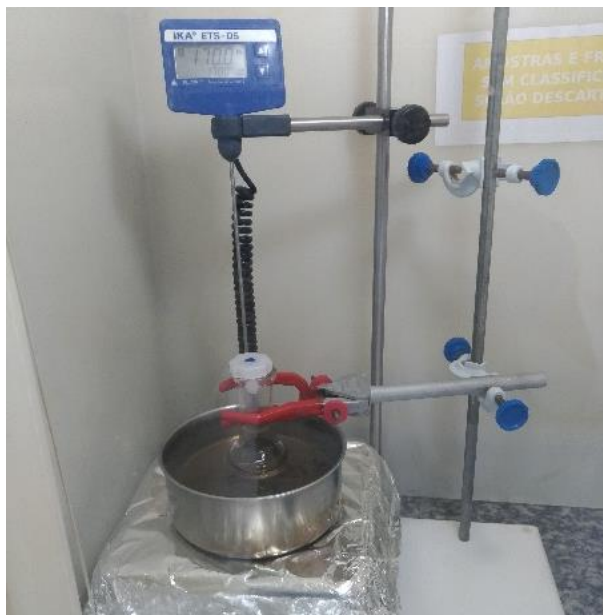
Figura 22 – Balão de fundo redondo, com EG, no banho de aquecimento
