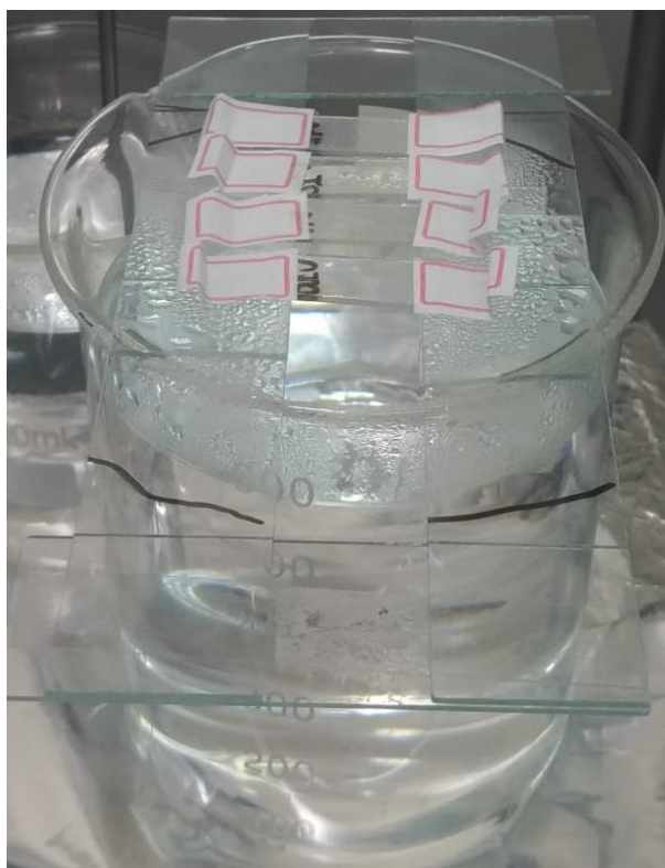
Figura 32 – Quatro amostras de filmes de nanofios de prata expostos ao vapor de ácido clorídrico
