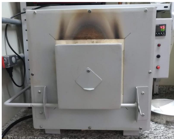
Figura 30 – Mufla com controle de temperatura utilizada para o tratamento térmico dos filmes de nanofios de prata
