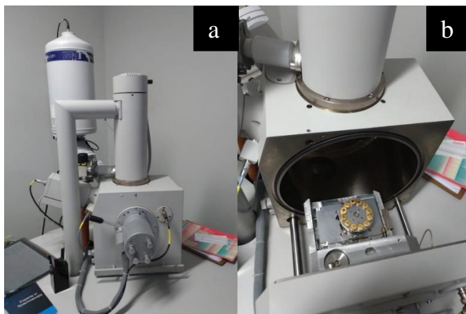
Figura 15 – Microscópio Eletrônico de Varredura (a) fechado e (b) aberto com as amostras metalizadas com ouro inseridas no suporte
