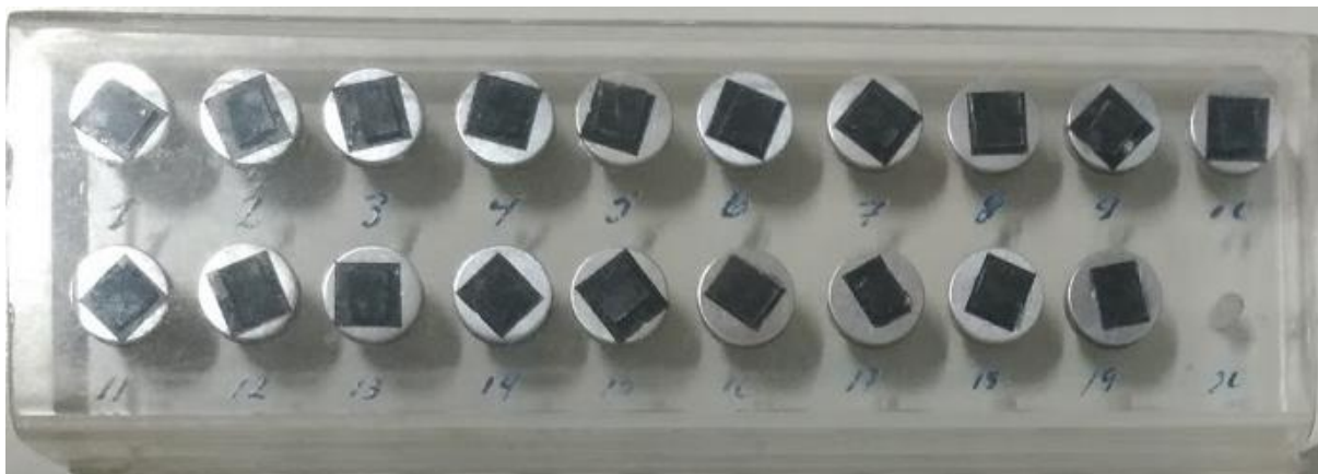
Figura 27 – Stubs com 19 amostras de filmes de nanofios de prata depositados sobre substrato de vidro sem recobrimento de ouro
