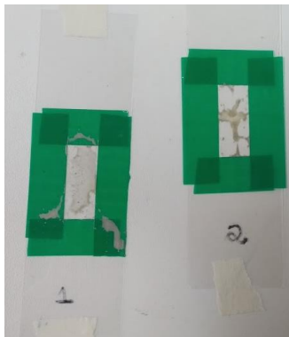
Figura 36 – Resultado da tentativa de deposição de filmes de nanofios de prata em substrato flexível por spin-coating
