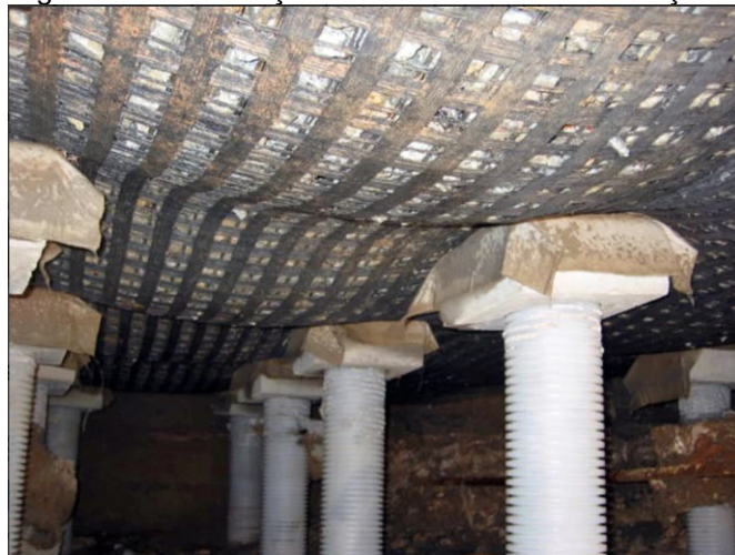
Figura 8 – Visualização do sistema de aterro reforçado.
