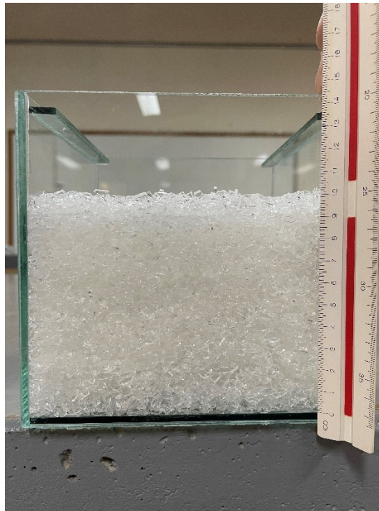
Fotografia 15 – Modelo físico preenchido com quartzo fundido triturado.
