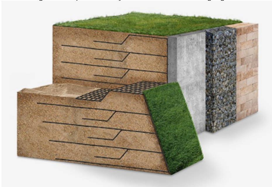
Figura 5 – Tipos de reforços em taludes utilizando geogrelha.
